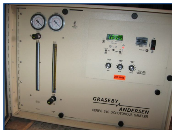
Figura 2.11 – Modulo di controllo del flusso.
