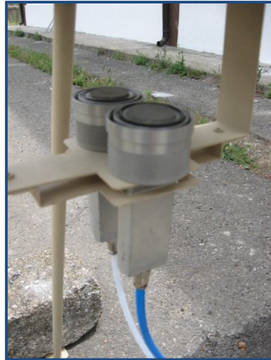
Figura 2.12 – Alloggiamenti dei filtri per il \text{PM}_{10} ed il \text{PM}_{2,5} .
