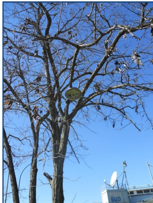
Figura 2.9 – Filtri con relativo supporto espositivo ( shelter ) collocati in un sito di campionamento.
