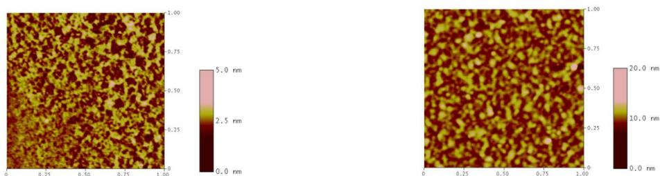
**Fig. III.39. A) Deposizione su silicio tramite LS del complesso 13 a differenti pressioni 5mN/m (sinistra), 12mN/m (centro) and 18 mN/m (destra). B) Deposizione su silicio tramite spin-coating del complesso 13, sciolto in cloroformio (sinistra) ed etanolo (destra)**
