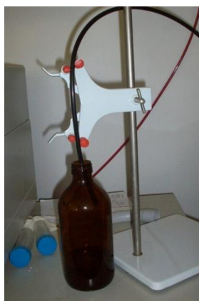
Figura 5. 7: Creazione delle condizioni anaerobiche mediante insufflazione di azoto gassoso
