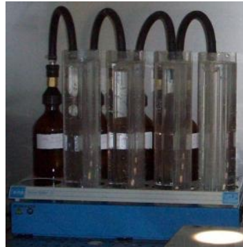
Figura 5. 8: Impianto pilota di tipo batch collegato ad un sistema di misura del biogas volumetrico
