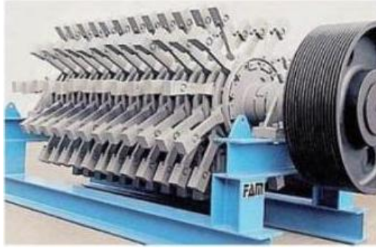
Figura 4. 2: Mulino a martello impiegato per la macinazione delle biomasse
