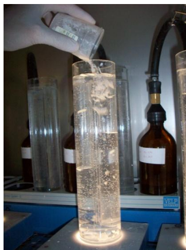
Figura 5. 11: Immissione della soda caustica nel cilindro di misurazione
