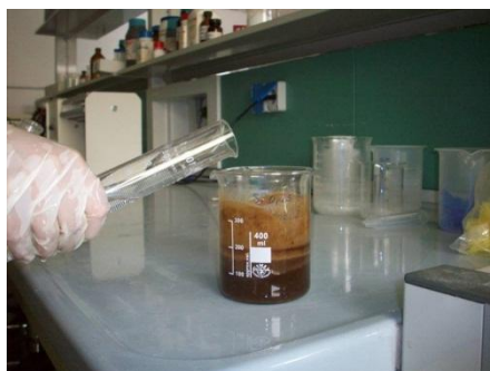
Figura 5. 1: Immissione del volume di H_2O_2 su un campione di sansa
