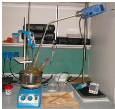
Figura 5. 3: Pallone a tre colli in vetro pirex in cui sono state condotte le analisi cinetiche
