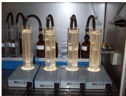
Figura 5. 10: Dettaglio dell'impianto. Si osservano le saracinesche di chiusura del tubo in gomma e la variazione dell'altezza del liquido nel cilindro ad esso collegato
