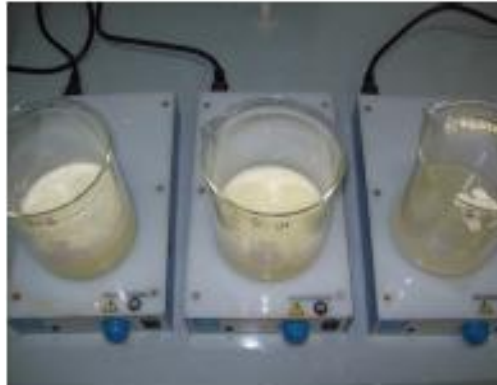
Figura 5. 5: Campioni di siero sottoposti ad ossidazione con perossido d'idrogeno
