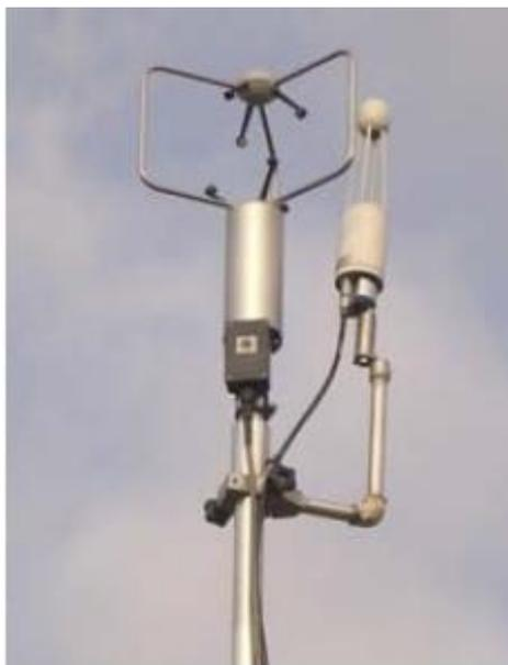
**Figura 22.** Anemometro sonico e analizzatore di gas
