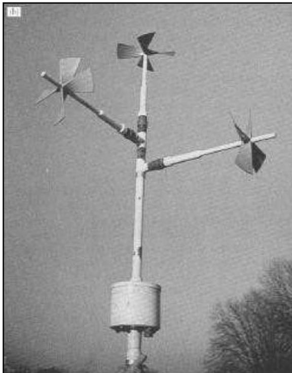
**Figura 19.** Anemometro ad elica triassiale
