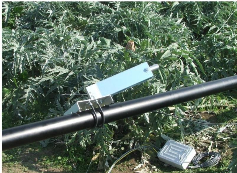
*Figura 38. Sensore di temperatura superficiale*
