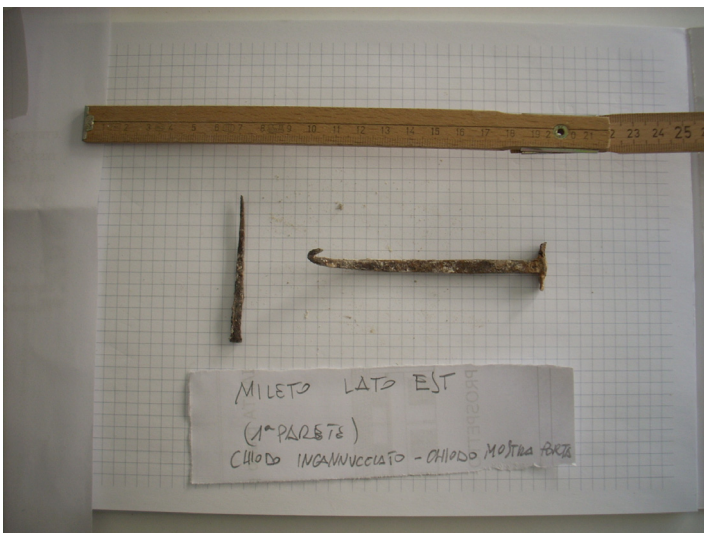
Fig. 52 Campione di chiodo prelevato dall'edificio vescovile di Mileto
