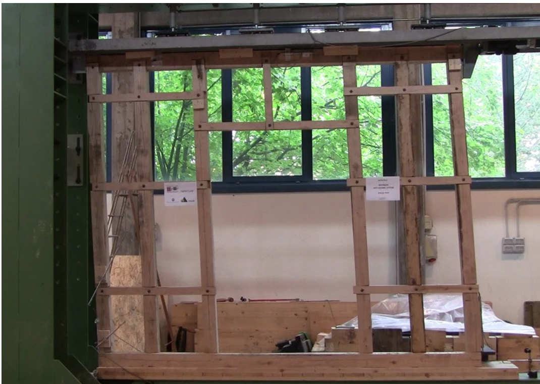
Fig. 72 Campione di sistema costruttivo Borbonico costituito da solo telaio ligneo.
