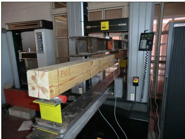
Fig. 5.37. Prova P01 a flessione.
