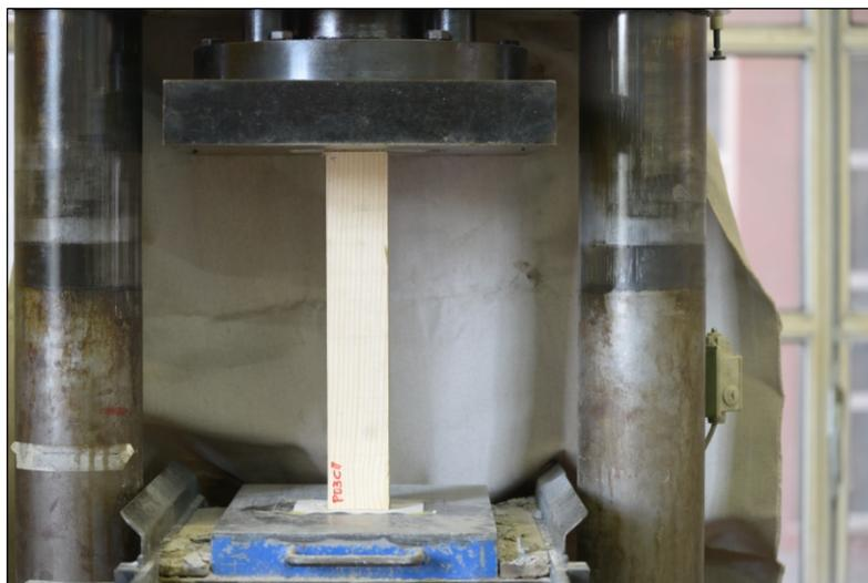
Fig. 5.18. Provino P03 compressione parallela nell'apparecchiatura di prova.
