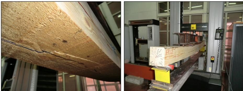
Figg. 5.47, 5.48. Particolari rottura provino P02.
