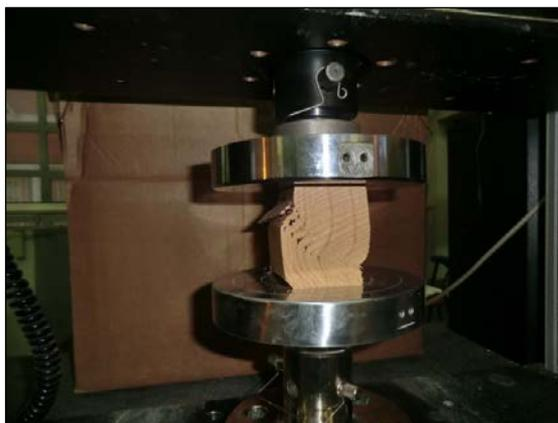
Fig. 5.69. Provino C02, a rottura.
