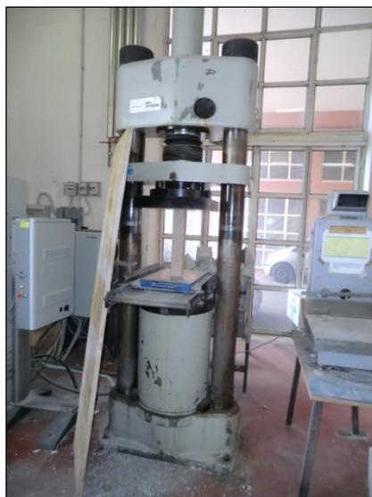
Fig. 5.52. Provino C01 compressione parallela e nell'apparecchiatura di prova.
