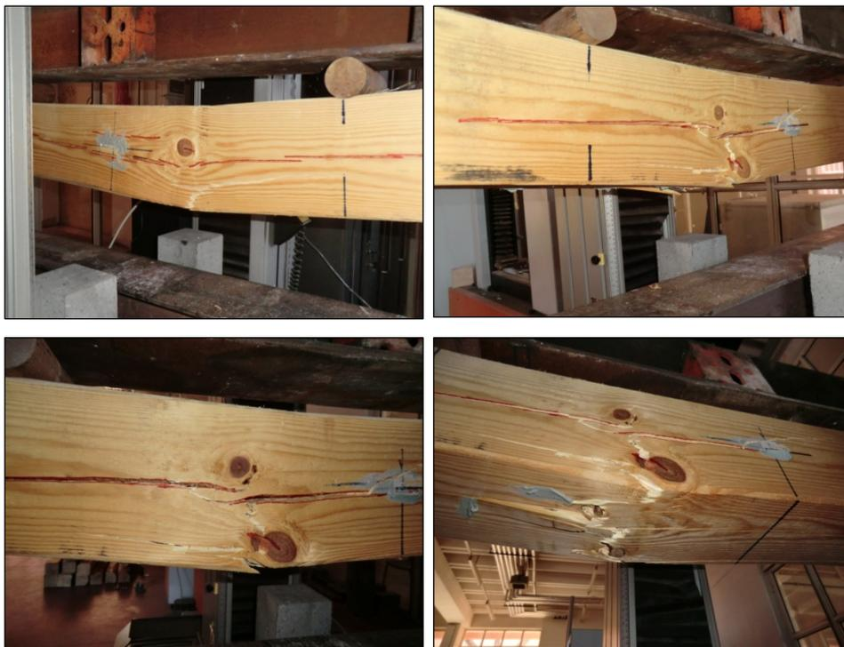
Figg. 5.42, 5.43, 5.44, 5.45. Particolari rottura provino P01.
