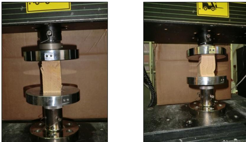
Figg. 5.66, 5.67. Provini C01 e C02, a rottura.
