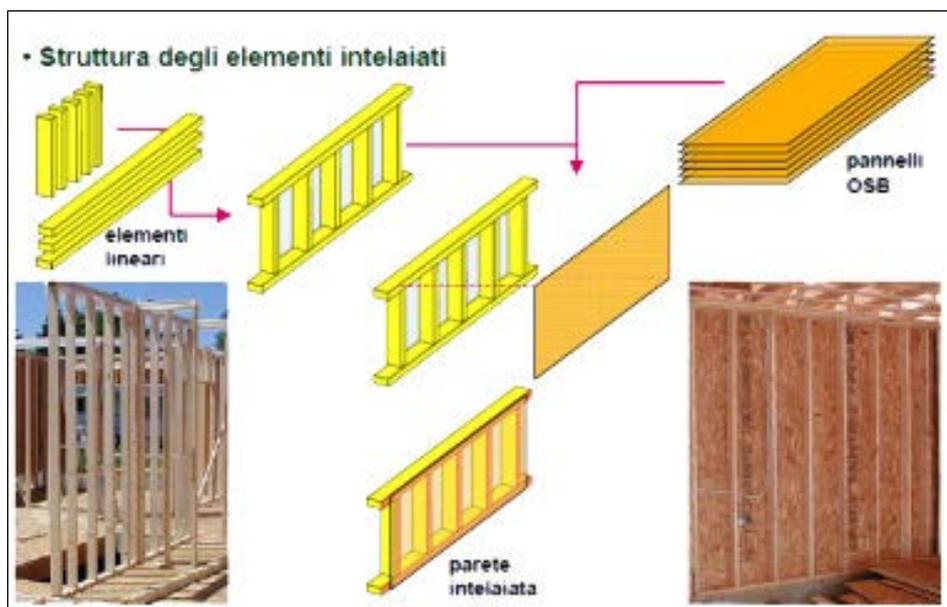
Fig. 3.11. Struttura della parete intelaiata tamponata.
