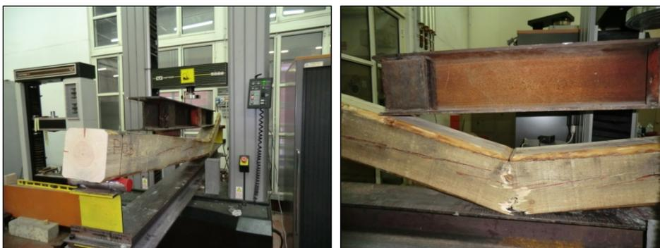
Figg. 5.50, 5.51. Particolari rottura provino P03.
