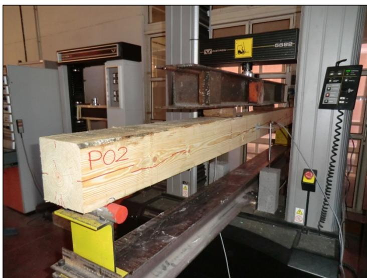
Fig. 5.46. Prova P02 a flessione.
