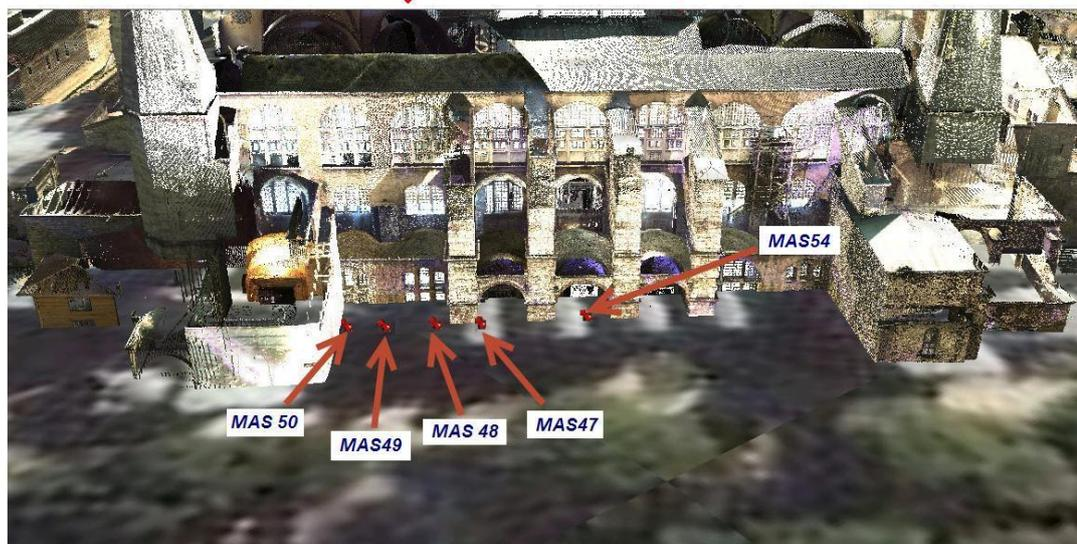
**Fig. 3.4.** Campioni prelevati dal prospetto ovest (ingresso principale) riportati nella schermata del GIS 3D. Nell'immagine sottostante sono riportati i campioni di malta prelevati nei resti della seconda Santa Sofia (MAS50-MAS47) e nei cunicoli sotterranei (MAS54).
