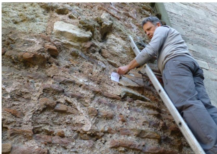
**Fig. 3.1.** Esempio di campionamento delle malte di allettamento, effettuato a Santa Sofia.
