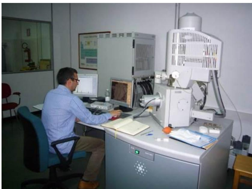
**Fig. 4.8.** Microscopio elettronico a scansione FEI Quanta 200 Instrument, dotato di un detector EDAX Si/Li, utilizzato per l'analisi dei campioni.
