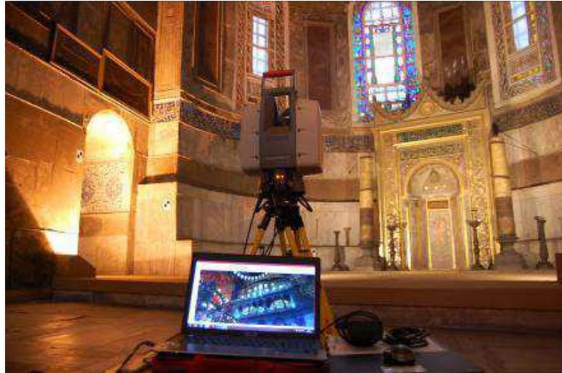
**Fig. 2.1.** Laser Scanner 3D utilizzato per il rilievo di Santa Sofia.
