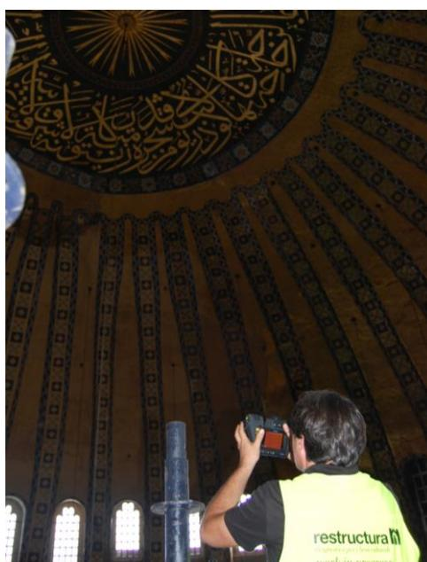
**Fig. 2.4.** Termocamera IR Flir Systems AB “SC640” utilizzata per le indagini a Santa Sofia.
