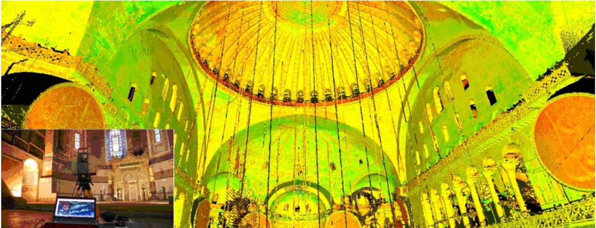
**Fig. 5.2.** Acquisizione laser scanner della nuvola di punti in 3D dell'interno di Santa Sofia.
