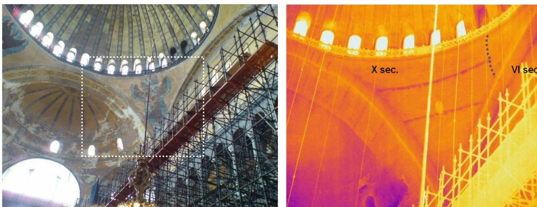
**Fig. 5.35.** Foto ed immagine termica del pennacchio nord-ovest dal centro della navata (Cappa et al., in press, modificato).
