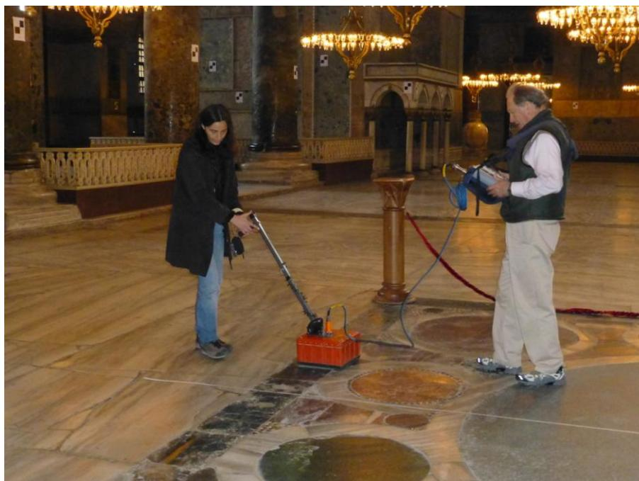
**Fig. 2.3.** Strumentazione GPR utilizzata per le indagini georadar a Santa Sofia.
