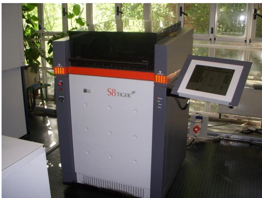
**Fig. 4.6.** Spettrometro di Fluorescenza Bruker S8 Tiger WD X-ray utilizzato per l'analisi.
