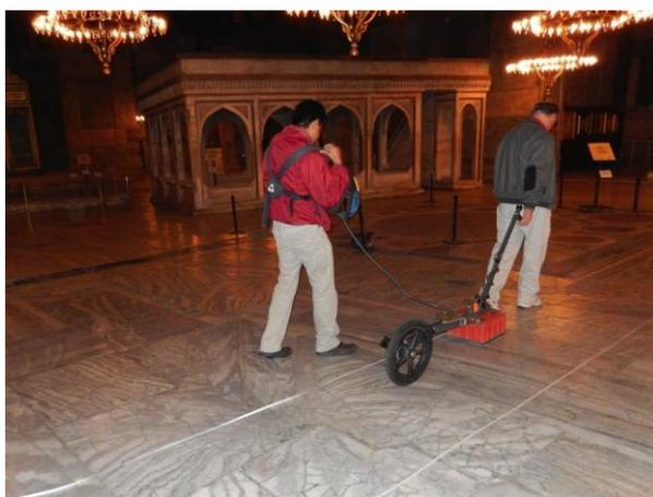
**Fig. 5.15.** Acquisizione dei dati georadar sul pavimento della navata centrale vicino al mosaico di marmo. Nella parte posteriore è visibile la galleria del muezzin.
