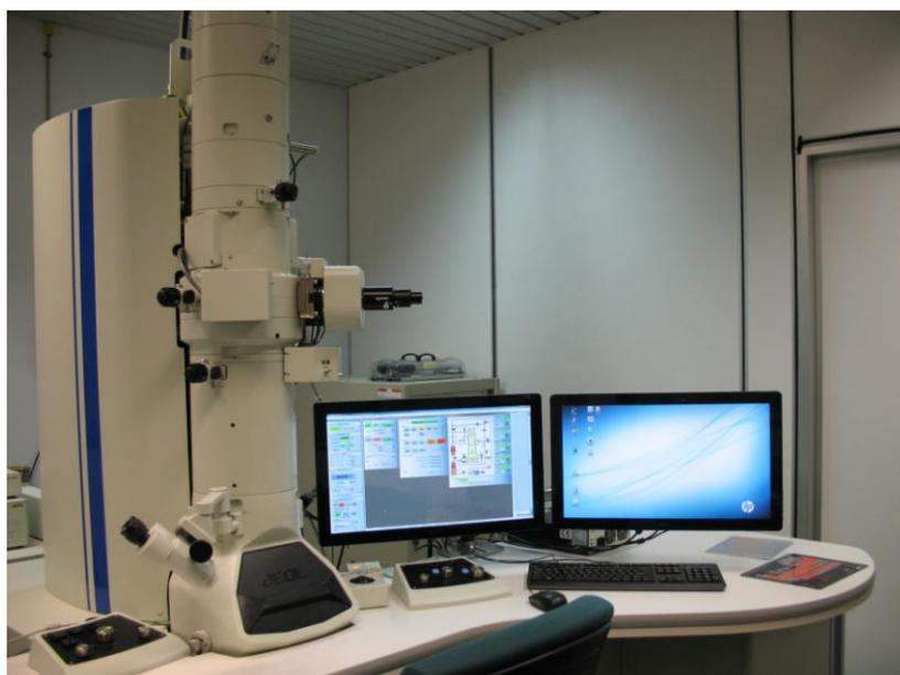
**Fig. 4.9.** Microscopio elettronico a trasmissione (TEM) Jeol JEM 1400 Plus utilizzato per l'analisi dei campioni.
