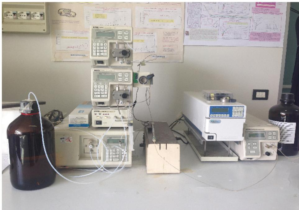
figura 3A.5: Fotografia della strumentazione utilizzata, HPLC
