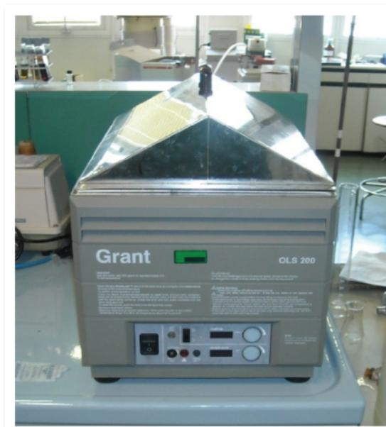
figura 3B.1: Bagno termostato ed agitato per le prove di transesterificazione in catalisi enzimatica
