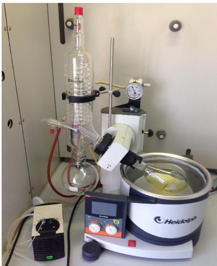
*figura 3A.4: Fotografia del processo di purificazione del biodiesel da acqua e metanolo in Rotavapor*
