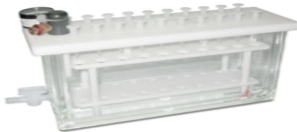
figura 3.8: Sistema MANIFOLD per la rimozione di composti organici in acqua
