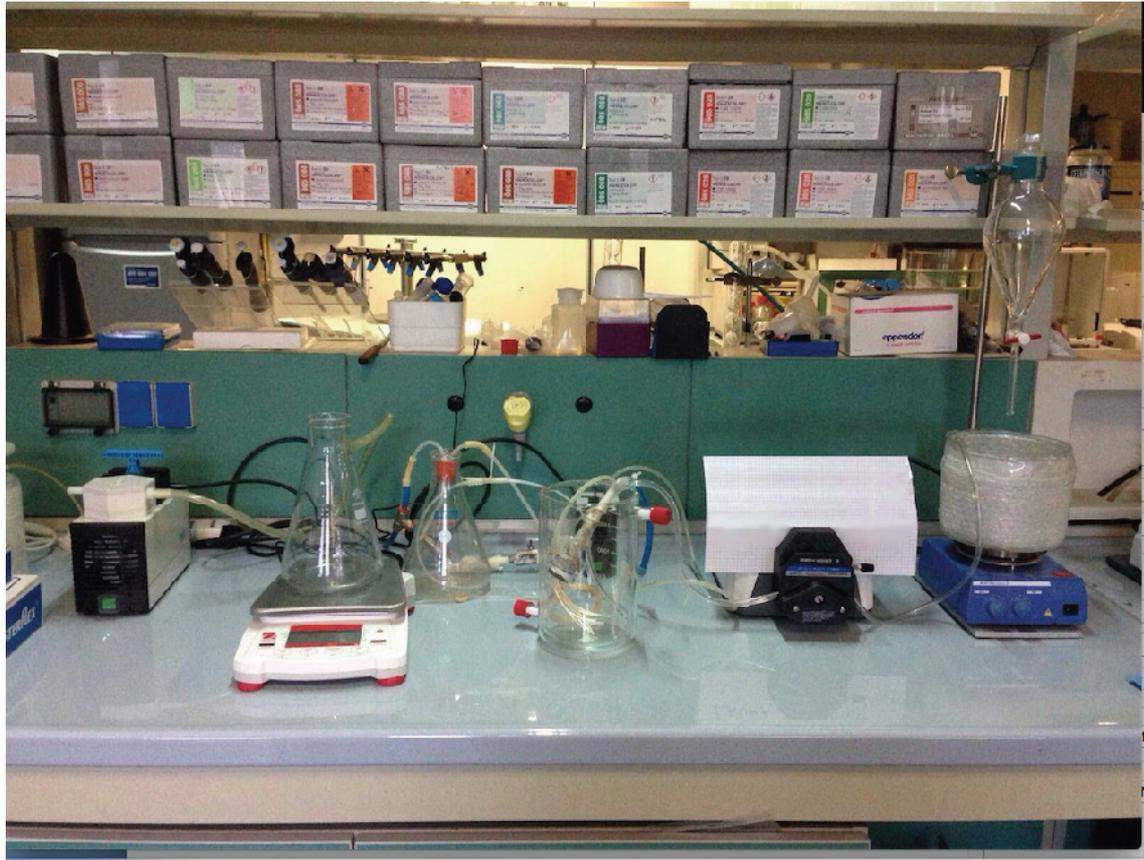
figura 3.7: *Installazione di laboratorio con MBR per il trattamento di acque reflue civili e meteoriche*
