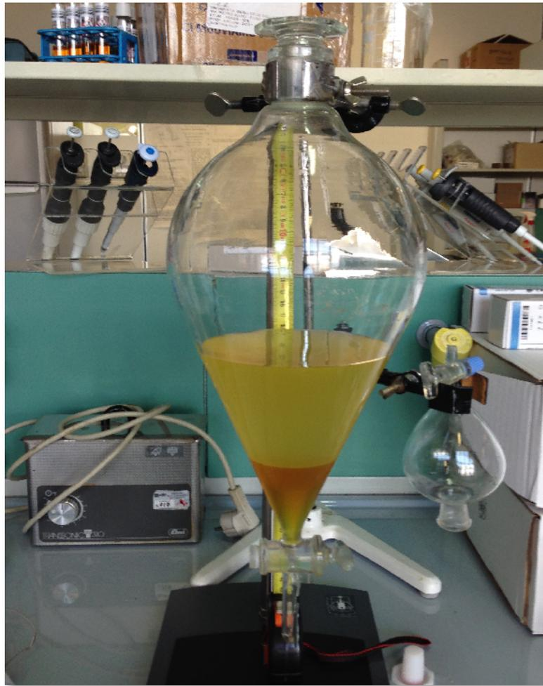
figura 3A.3: Fotografia del processo di separazione per stratificazione del glicerolo (sul fondo) dagli esteri (miscela liquida di colore giallo, surnatante)
