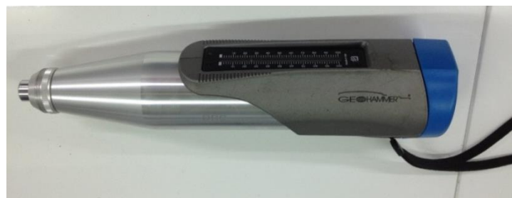
Fig. 5.21. Schmidt hammer: Geohammer L-Type.
