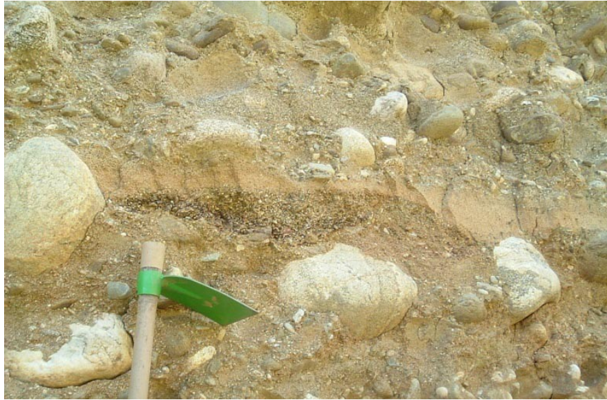
Figura 3.3: Particolare delle lenti ghiaioso-sabbiose intercalate nei livelli più grossolani.
