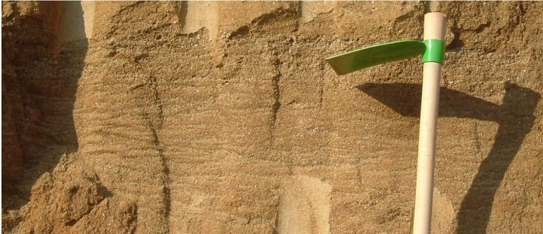
Figura 3.9: Sabbie medio-grossolane, a stratificazione incrociata alla scala dei ripples .
