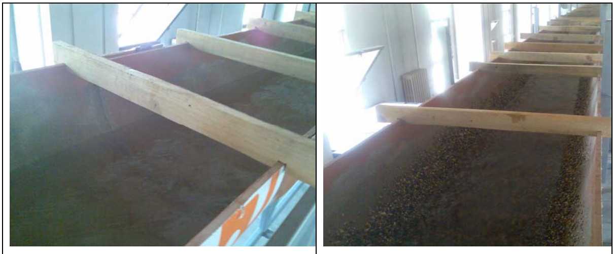
Figura 64: Scabrezza del fondo - sezione circolare - 0.25 e 3.0 mm
