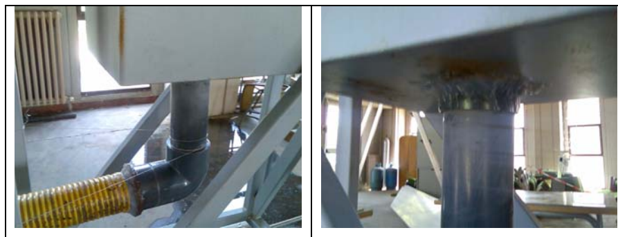
Figura 46: Particolare del giunto al cassone di monte
