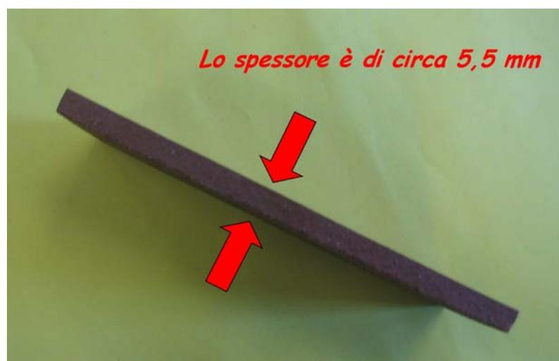
*Fig. 8.2.8 – Spessore della piastrella contenente il 7% di Fango*
