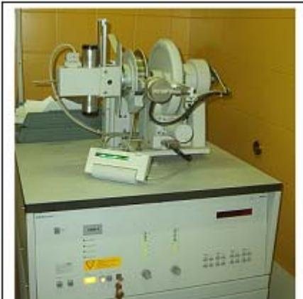
**Fig. 4.1.2** Diffrattometro Philips PW 1830
