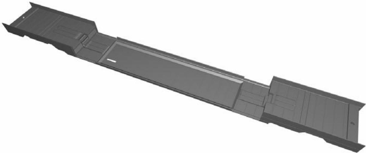
**Figura 48 Scheletro del corpo in lega di alluminio 6005.**
