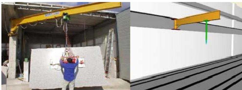
**Figura 44** Modello fisico e modello digitale del ponte elevatore.
