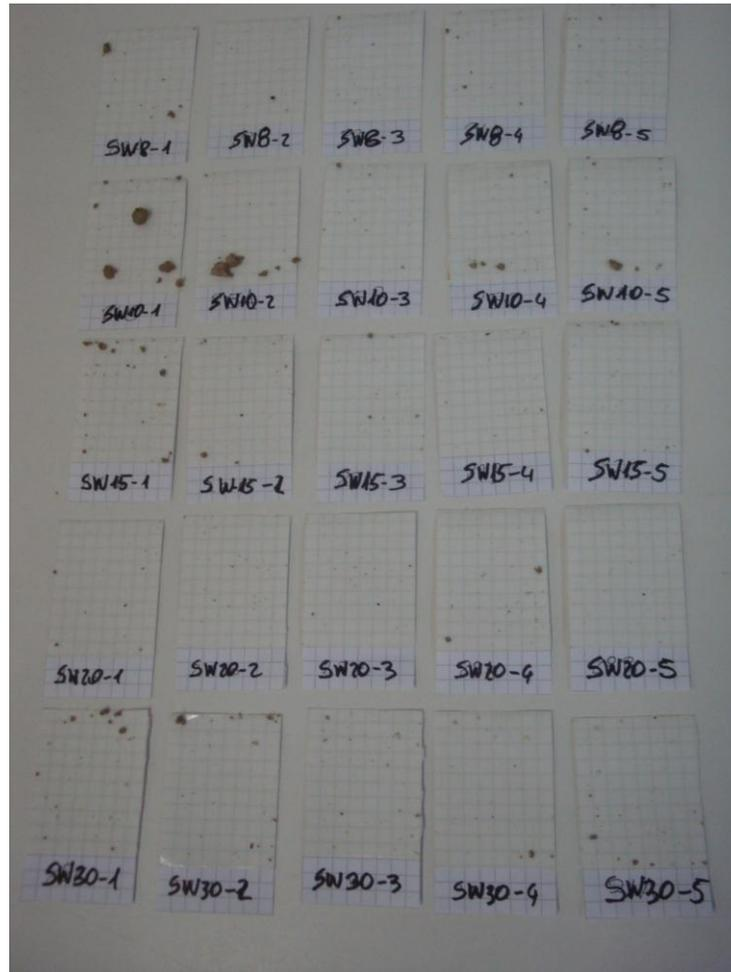
*Fig. 7.25: Peeling test provini consolidati con Syton X30 .*
