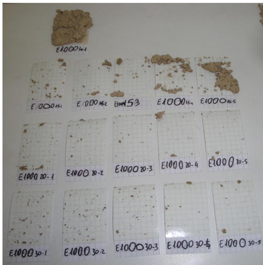
**Fig. 7.22: Peeling test provini consolidati con Estel 1000 .**
