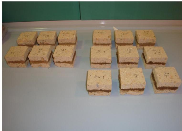
*Fig. 6.39: Preparazione provini per testare la resistenza delle stucature.*
