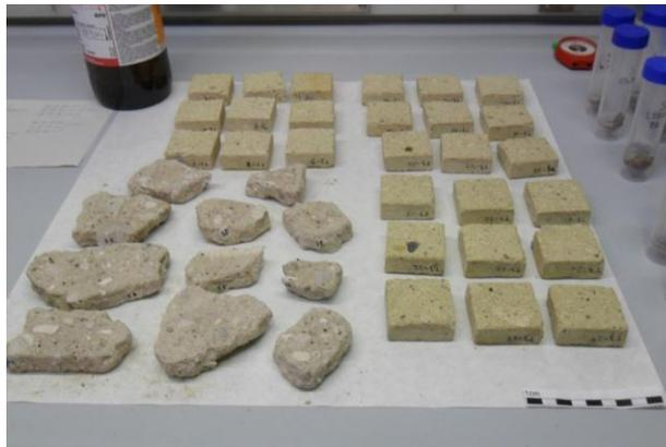
***Fig. 6.35: Provini ricavati dal taglio dei campioni S1 e T3; data l'elevata friabilità non è stato possibile ottenere da S1 provini di dimensioni conformi agli standard.***
