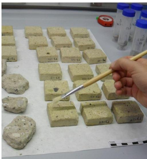
*Fig. 6.36: Applicazione dei prodotti tramite pennello.*
