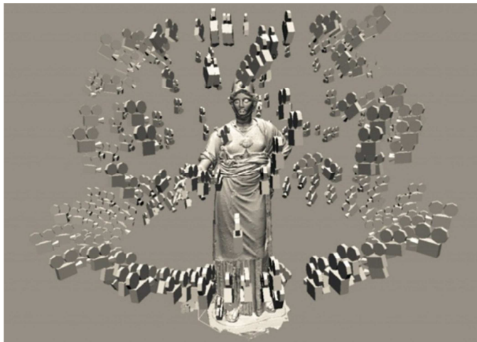
Fig. 1.18 – Visualizzazione delle 297 posizioni della range camera , impiegate per definire compiutamente la statua della Minerva di Arezzo (Visual Computing Lab, ISTI-CNR).
