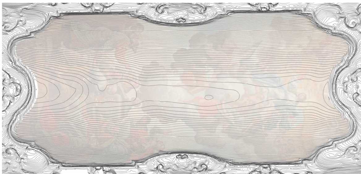
PARTICOLARE DELL'IPOGRAFIA DELL'AULA CON CURVE DI LIVELLO (PASSO=1 cm)
