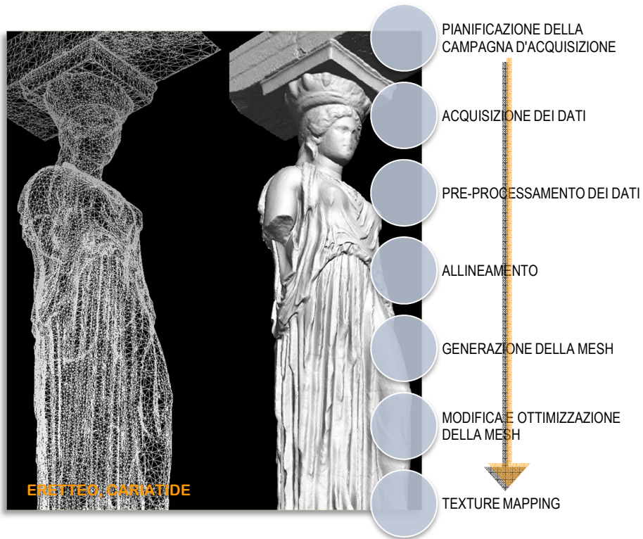
Fig. 1.17 – Diagramma di flusso del processo di modellazione tridimensionale.
