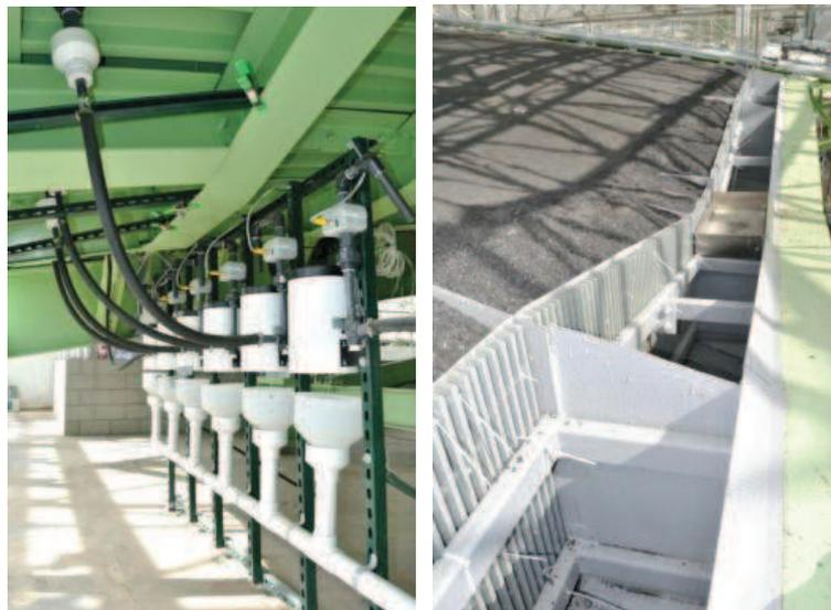
**Figura 6.16. Rappresentazione degli strumenti usati per monitorare il flusso di infiltrazione e le sei sottosezioni della facciata terminale del bacino Biosphere 2 LEO**
