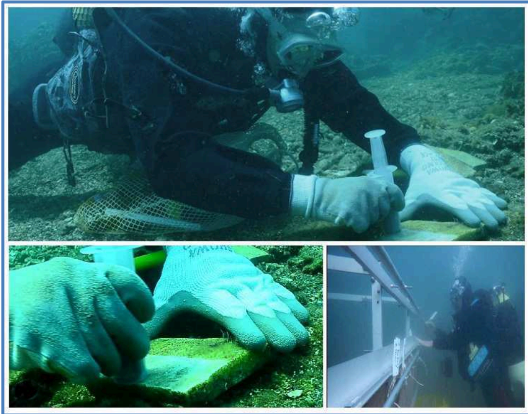
Figura 29 - Trattamenti in situ e adattamento delle lastre nel sistema portacampioni.
