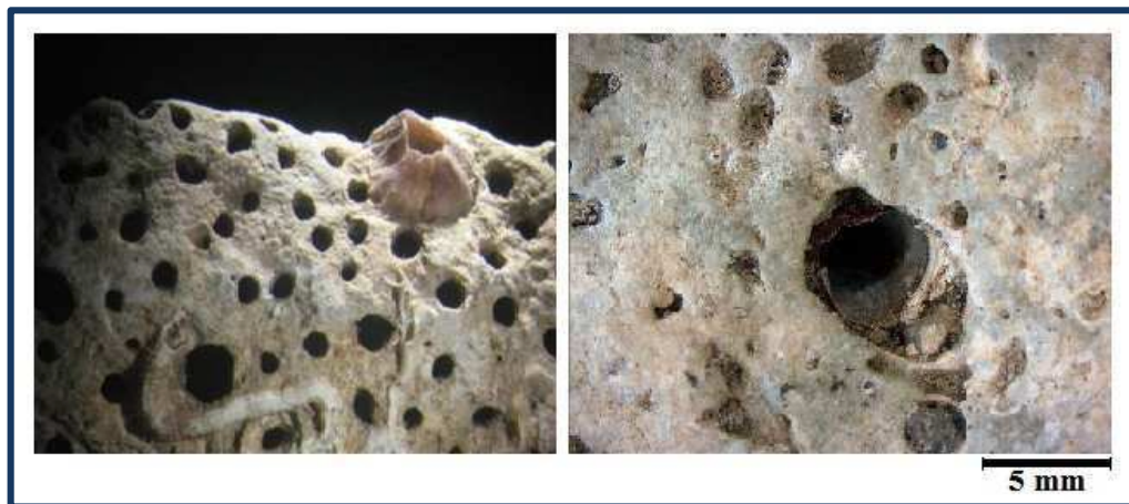
Figura 2 - Immagini allo stereo-microscopio di forme di pitting e macroboring , entrambe prodotte dall'azione di organismi endolitici.
