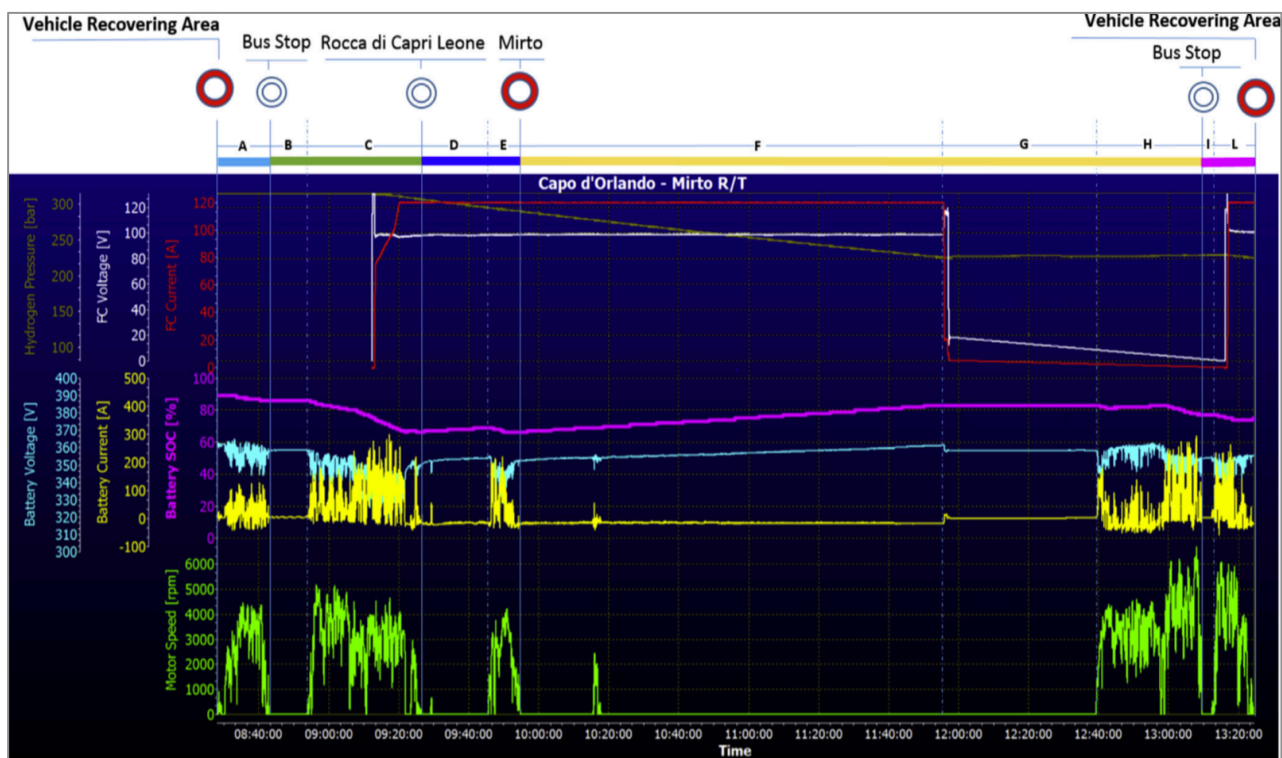
Figura 5.3: Percorso n. 1 (Mirto): Velocità del motore e principali variabili del FC system e delle batterie
