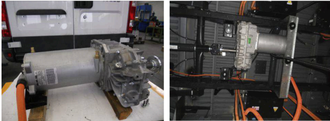
Figura 4.2: Motore asincrono (40 kW) accoppiato con adattatore di velocità, a banco e installato sul bus
