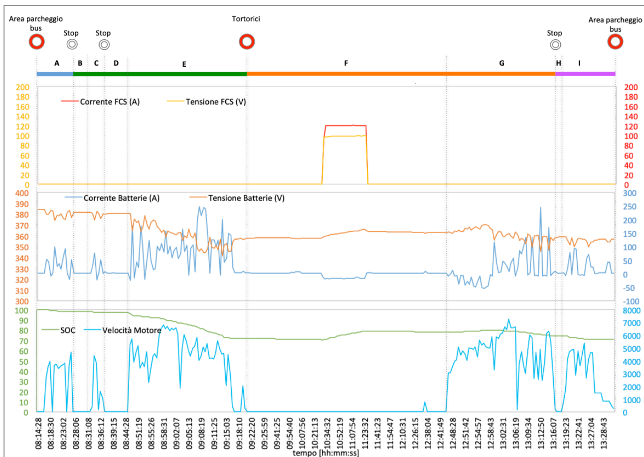
Figura 5.5: Percorso n. 7 (Tortorici): Velocità del motore e principali variabili del FC system e delle batterie
