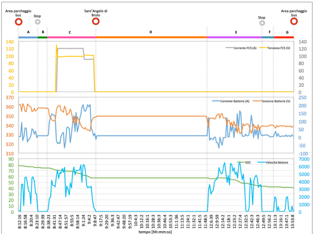
Figura 5.9: Percorso n. 11 (Sant'Angelo di Brolo): Velocità del motore e principali variabili del FC system e delle batterie
