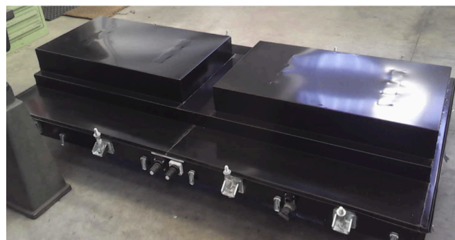
Figura 4.4: Battery Energy System - BES (potenza nominale: 30 kW, energia: 70 kWh)
