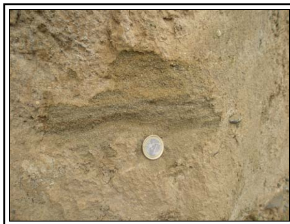
Figura 4.22 – Particolare di campionamento delle intercalazioni sabbiose.
