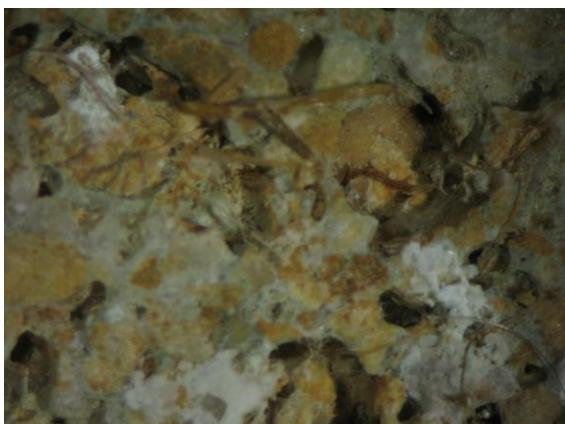
Fig. 5 - Filamenti algali e talli incrostanti sul provino KG6
