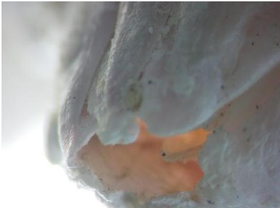
Fig. 3- Balanidi sul provino C3
