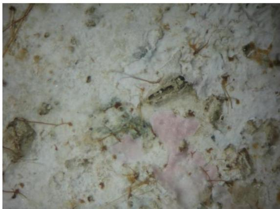
Fig. 7 - Tallo algale incrostante con filamenti di alghe brune sul provino SL6
