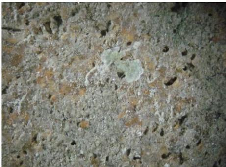
Fig. 5 - Tallo incrostante sul provino KF2
