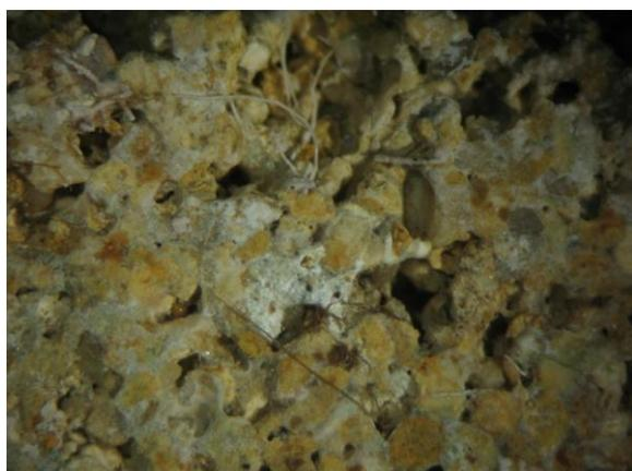
Fig. 9 - Filamenti di *corallina elongata* sul provino KG1
