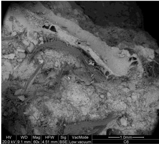
Fig. 5 - Presenza di alghe e guscio calcareo sul provino C6
