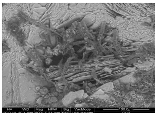
*Fig. 81 - Attacco biologico alla biotite nel provino GG1*
