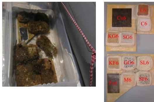
Fig. 68 - Confronto della serie 6 di provini prima (a destra) e dopo l'immersione in mare per 12 mesi (a sinistra)
