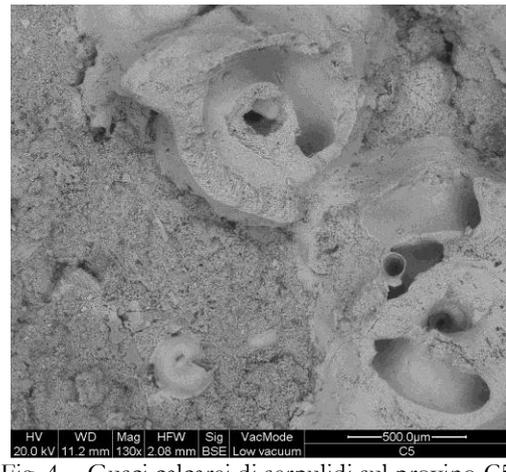
Fig. 4 - Gusci calcarei di serpulidi sul provino C5
