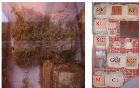
Fig. 67 - Confronto della serie 1 di provini prima (a destra) e dopo l'immersione in mare per 12 mesi (a sinistra)
