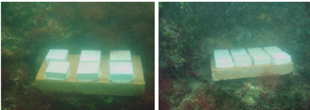
Fig. 89 - Provini di materiale lapideo artificiale immersi a Baia
