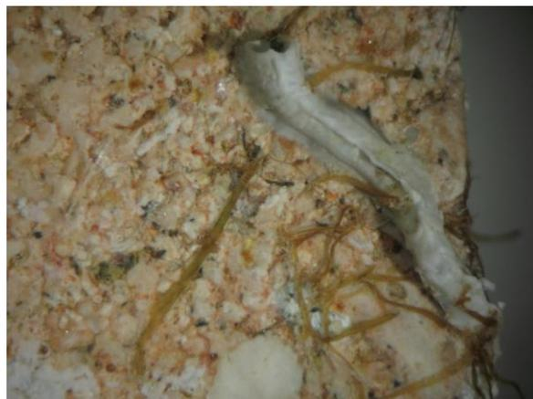
Fig. 8 - Guscio di serpulide e filamenti algali sul provino M6
