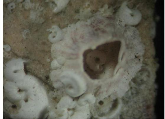
Fig. 2 - Balanidi e serpulidi sul provino C2
