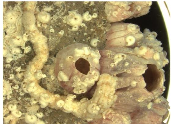
Fig. 6 - Balanidi e serpulidi sul provino C7
