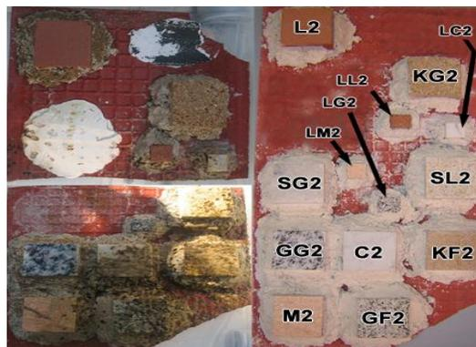
Fig. 54 - Confronto della serie 2 di provini. Prima (a destra) e dopo l'immersione in mare per 3 mesi (a sinistra)
