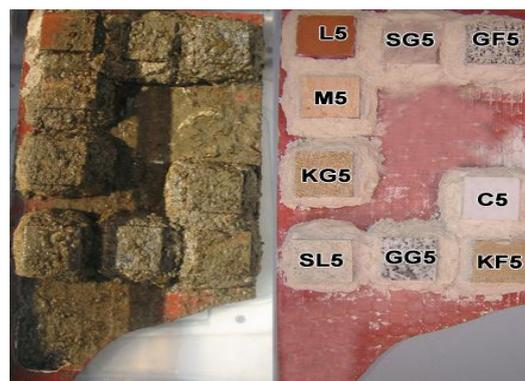
Fig. 56 - Confronto della serie 5 di provini prima (a destra) e dopo l'immersione in mare per 3 mesi (a sinistra)
