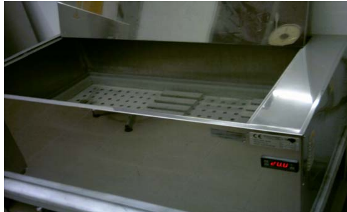
Fig. 5.76b - Ambiente di stagionatura dei provini di cls per la valutazione del ritiro
