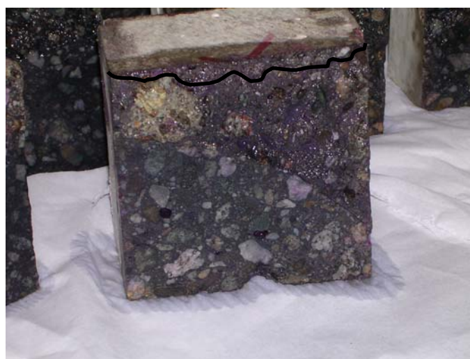
Fig. 5.65 - Provino di cls a fine prova con linea di demarcazione fronte di avanzamento dello ione solfato
