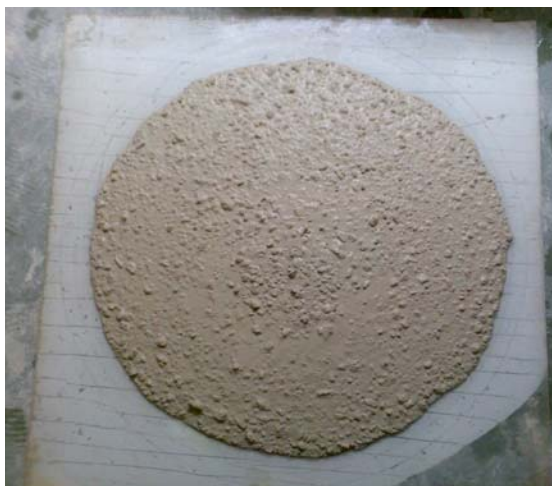
Fig. 6.1 - Prova di spandimento per il calcestruzzo confezionato con cemento bianco CEM I 52,5 R, filler calcareo e zeolite (miscela 8).
