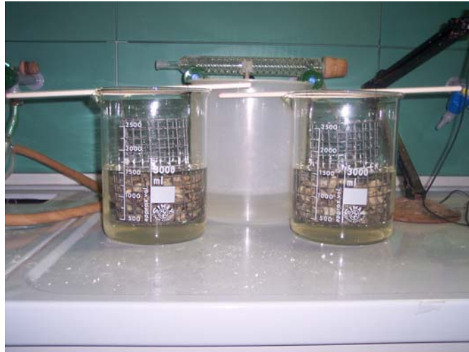
Fig. 4.12 - Aggregati immersi in una soluzione satura di solfato di magnesio.
