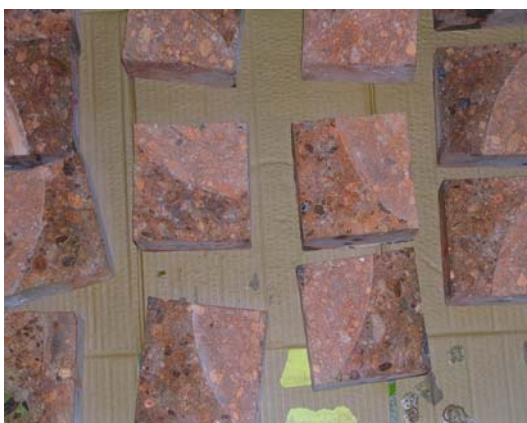
Fig. 5.55 - Provini a contatto con il Nitrato d'argento
