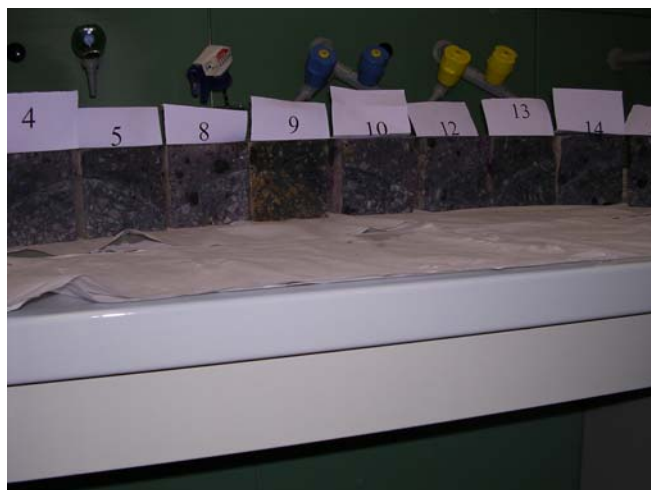
Fig. 5.64 - Provini di cls dopo il contatto con la miscela di cloruro di bario e permanganato di potassio
