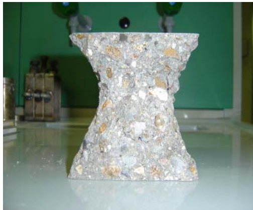
Fig. 5.23 - Provino di calcestruzzo realizzato con CEM I 42,5 R ed il 10% di aggiunta di zeolite 5A industriale, dopo rottura a 28 giorni.
