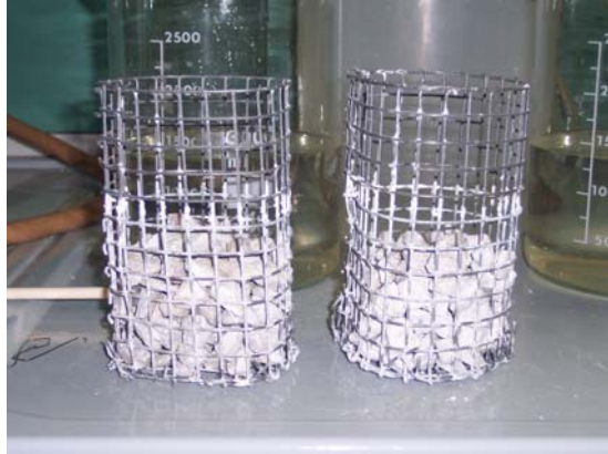
Fig. 4.94 - Aggregati dopo la prova al solfato di magnesio.
