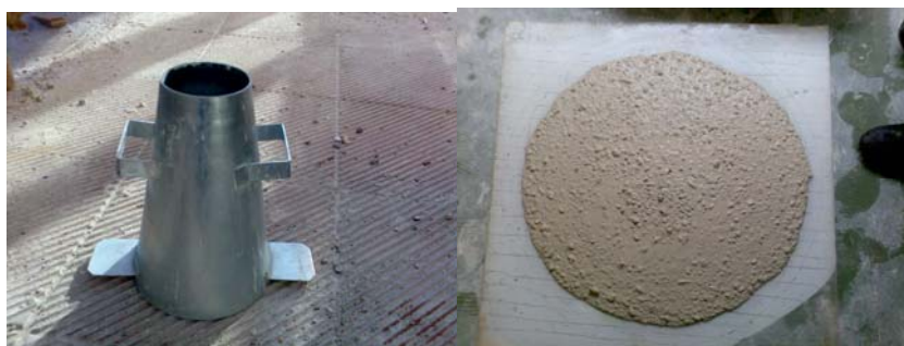
Fig. 4.9 - Alcune immagini sullo svolgimento dello slump-flow test.
