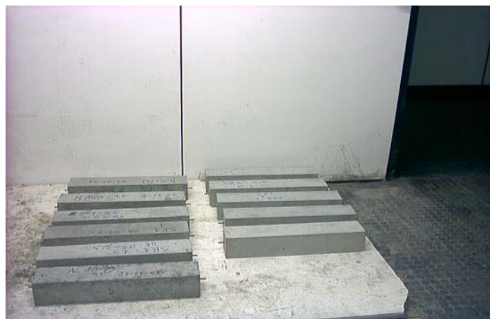
Fig. 5.76a - Provini di cls per la valutazione del ritiro
