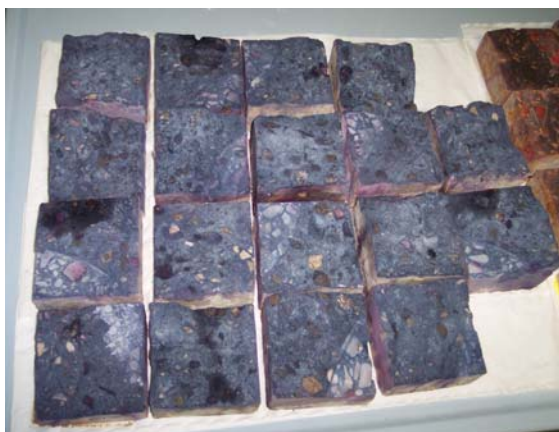
Fig. 7.39 - I provini dopo l'attacco chimico da solfati.
