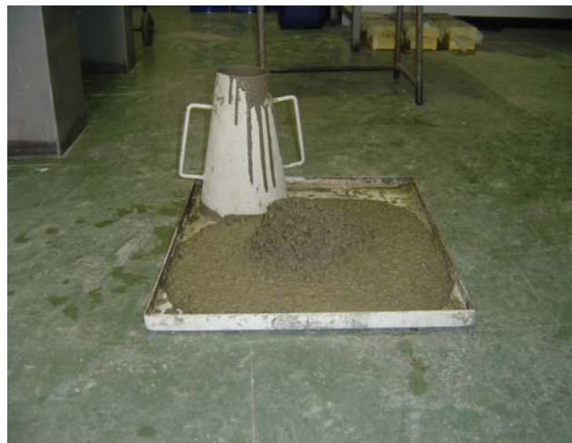
Fig. 5.18 - Lavorabilità dell'impasto di calcestruzzo realizzato con il CEM I 42,5 R senza aggiunta (T.Q.)
