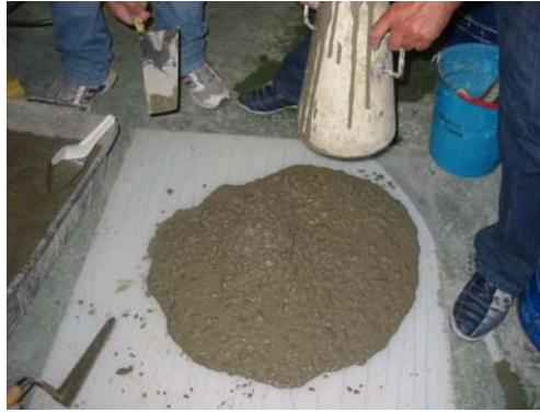
Fig. 7.8 - Prova di abbassamento al cono di Abrams della miscela I.
