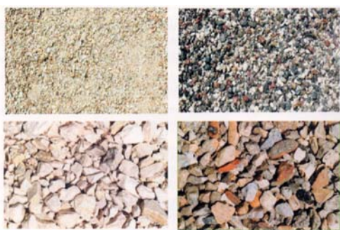
Fig. 1.15 - Confronto visivo tra aggregati naturali (a sinistra) e riciclati (a destra).
