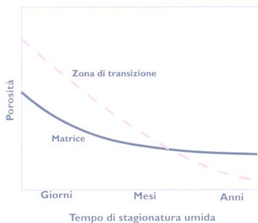
Fig. 1.3– Andamento schematico nel tempo della porosità nella matrice cementizia e della zona di transizione del calcestruzzo
