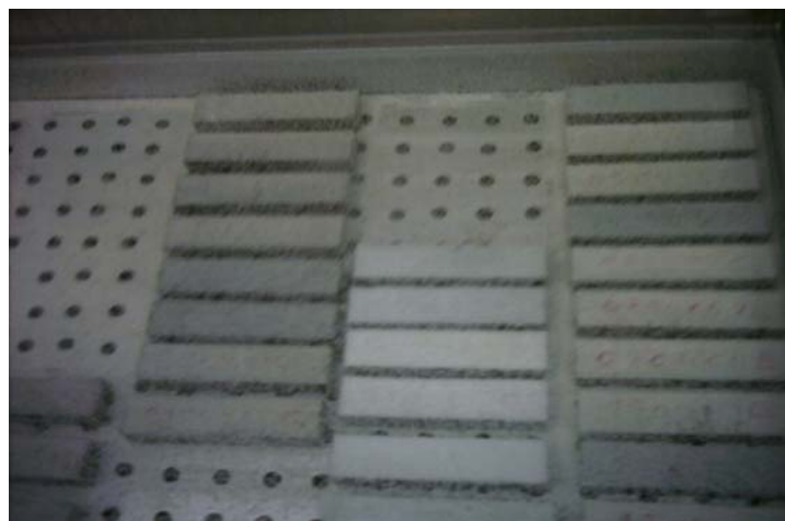
Fig. 5.76c - Disposizione tipica dei provini di cls all'interno della camera -armadio di stagionatura.
