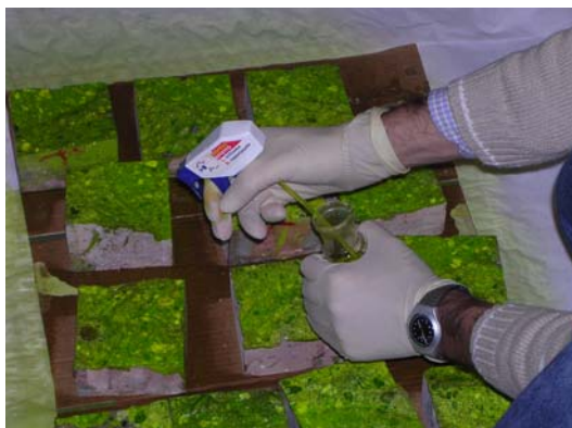
Fig. 5.54 - Provini impregnati con fluoresceina
