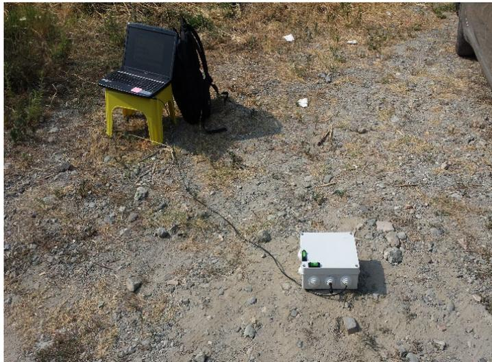
*Figura 3.11 b) Esterno tromografo sperimentale collegato al PC.*
