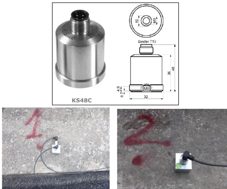
Figura 4.39: Trasduttori di accelerazione
