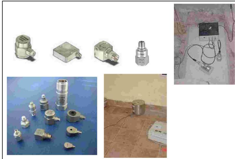
*Figura 4.8: Vari tipi di accelerometri*
