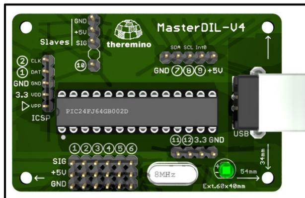
*Figura 3.4 Modulo Master Dil - V4, utile per numerose applicazioni nel campo della geologia, geotecnica geofisica e misure ambientali.*
