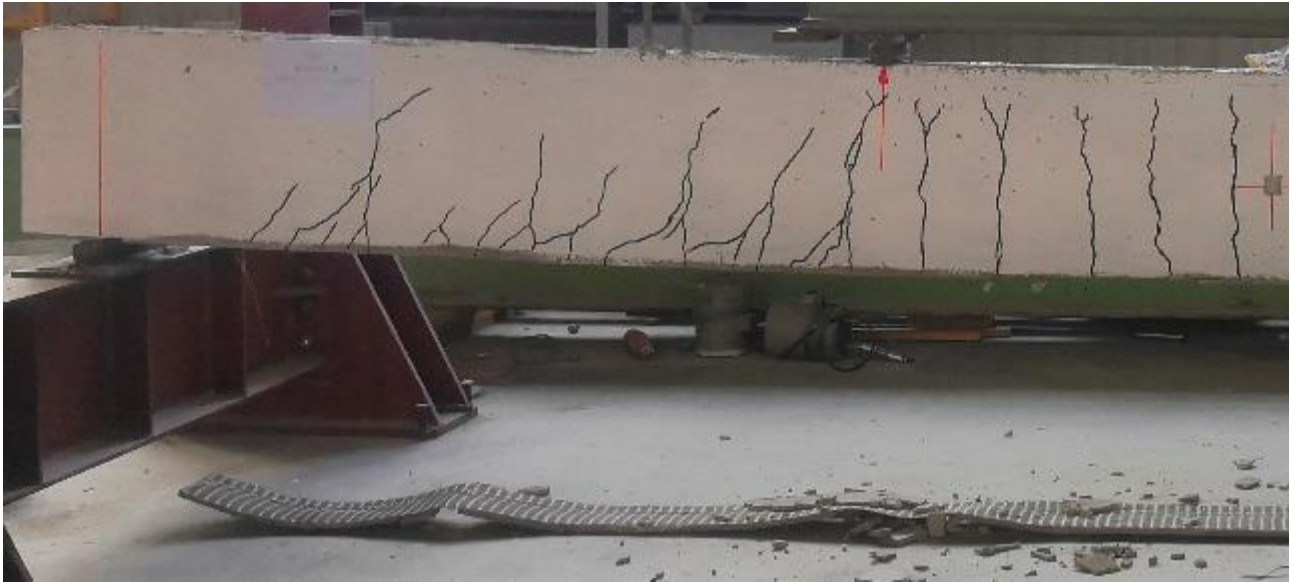
Figura 6.13 - Modalità di rottura trave M-EB_SS_B.
