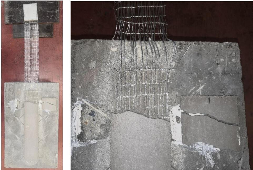
Figura 3.16 - Modalità di rottura del campione SS (1100)_BMN_1.
