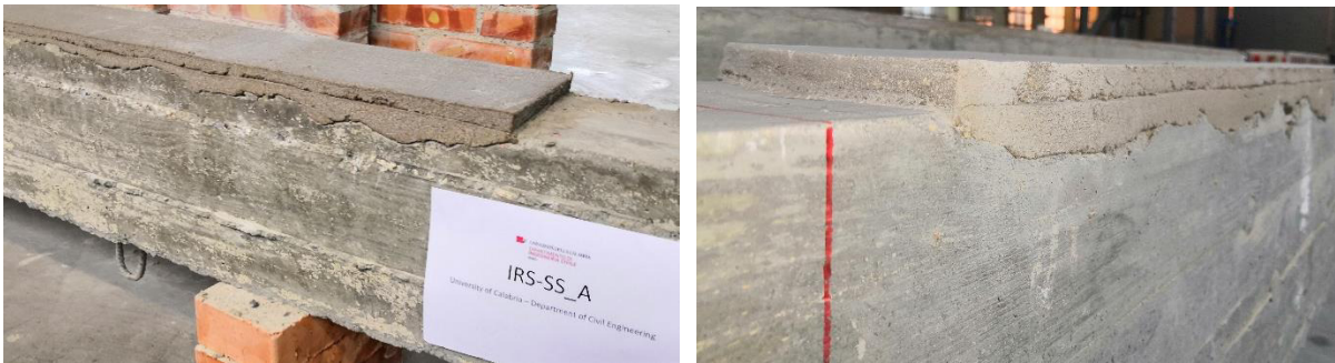
Figura 4.7 - Intervento di rinforzo con tecnica IRS completo.
