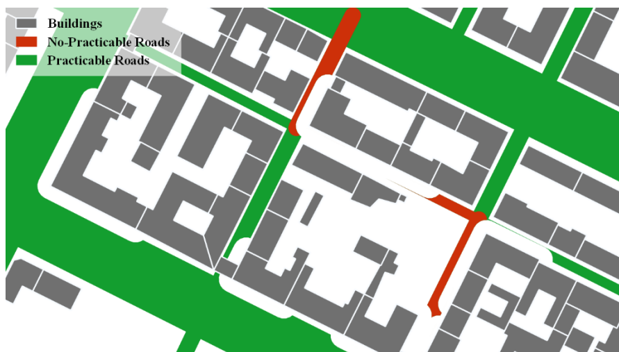
Fig. 3.13 - Esempio di operazione difference per ottenere i layer "No-Practicable Roads" e "Practicable Roads".
