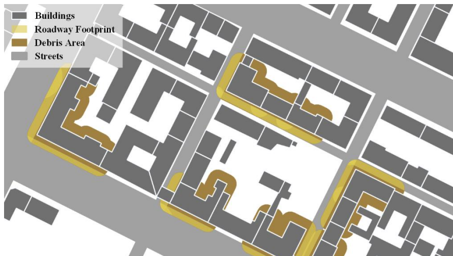
Fig. 3.12 - Esempio di operazione buffer per ottenere il layer "Debris Area".
