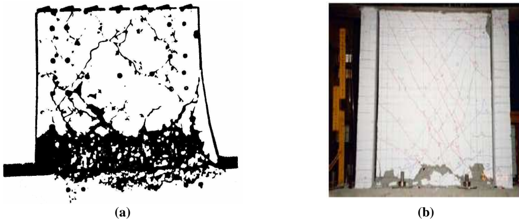
Figura 2.15. Rottura di tipo sliding shear : (a) schematizzazione grafica [Park e Paulay, 1975]; (b) risultato di prova sperimentale [Chiou et al. , 2006].
