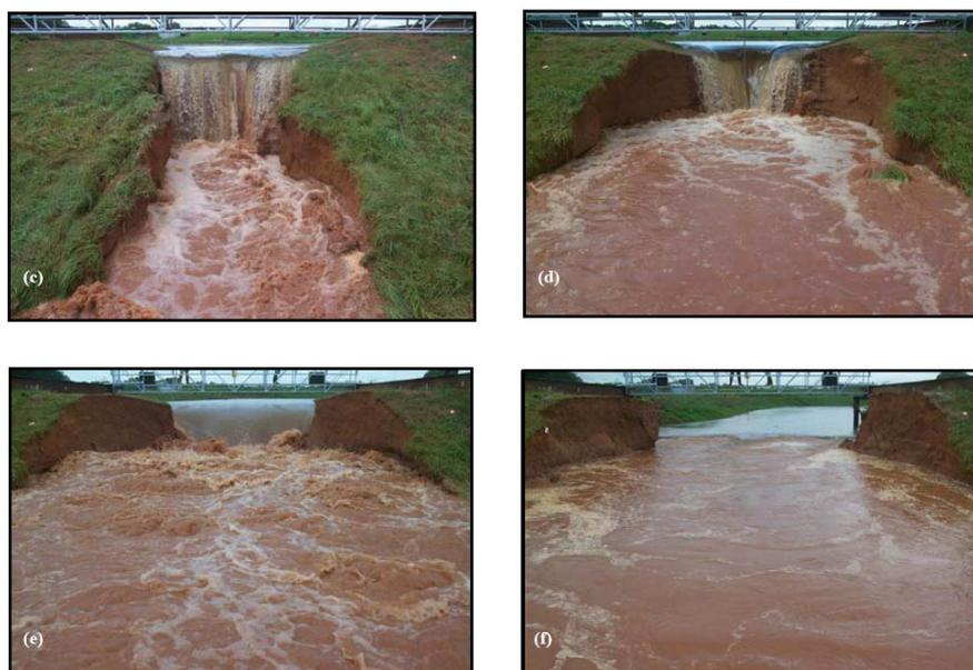
Figura 2.5: Meccanismo di formazione ed avanzamento dell'*headcut* nelle dighe in materiale coesivo (Hanson et al., 2005).
