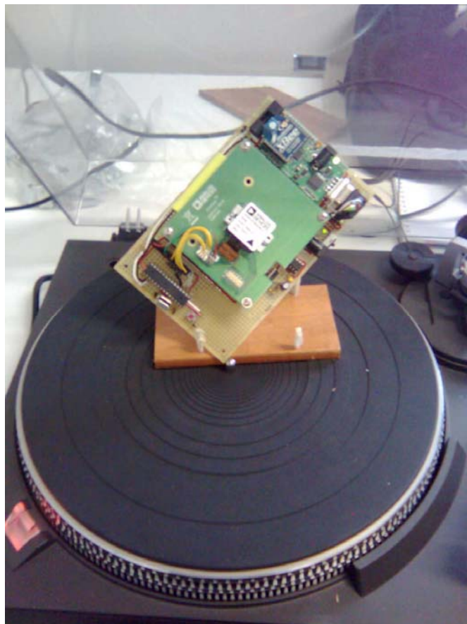
Fig. 6.8 - Rappresentazione di una delle prove eseguite per la calibrazione dei giroscopi
