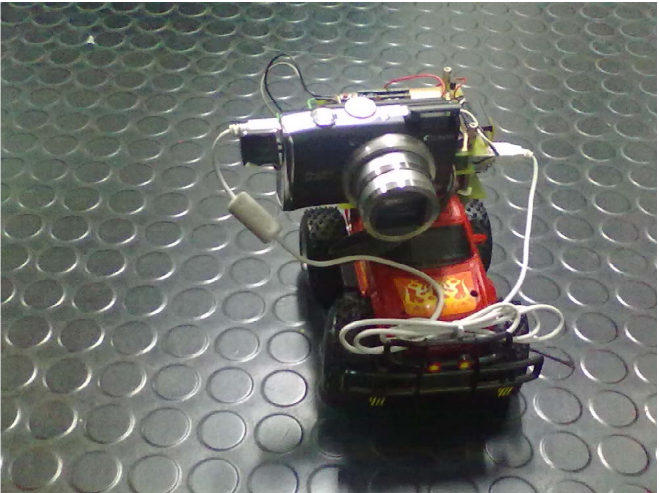
Fig. 9.3 – La fotocamera implementata con il sistema integrato. Il tutto è poi posto su di una macchina giocattolo per l'esecuzione di alcune prove di acquisizione
