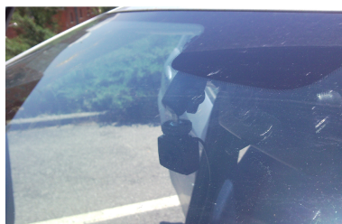
Figura 9.23. Videocamera installata dietro il parabrezza
