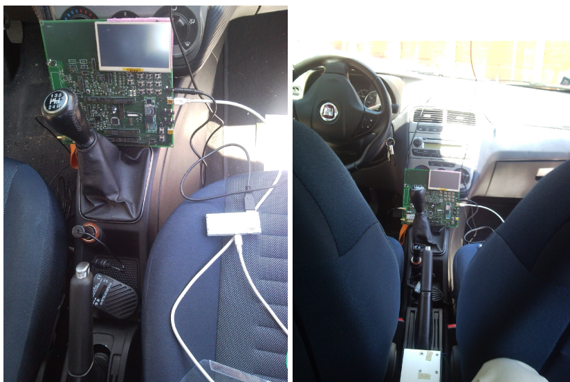
Figura 9.27. Scheda embedded e alimentatore a bordo vettura
