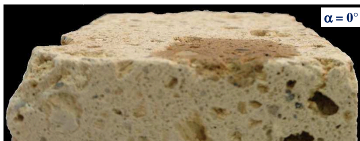
Fig. 5.6 – Foto ravvicinata della superficie di un provino di TGN sottoposto a “test della goccia”. È visibile la zona in cui la goccia d’acqua è caduta e viene immediatamente assorbita dal materiale. Non è possibile, di conseguenza, misurare e/o quantificare l’angolo che essa stessa dovrebbe formare con la superficie del materiale.
