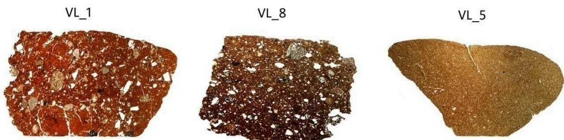
Fig. 4.16 – Scansioni di sezioni sottili di tre campioni rappresentativi. La diversa colorazione è essere indice di particolari condizioni di cottura e, di conseguenza, da informazioni sulle tecniche produttive. Nei campioni VL_1 e VL_8 si osservano inclusi e vuoti di grande dimensione, rispetto alla sezione VL_5, più compatta. Tali differenze sono imputabili alle diverse metodologie di preparazione, legate alla composizione chimica, dipendente altresì dalla tipologia di materiali utilizzati per la loro realizzazione.
