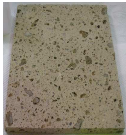
Fig. 3.4 – Esempio di lastra di TGN di dimensioni 30x20x2 cm. – Provenienza: cava “Gallo”, Tufino – Quarto (Na)
