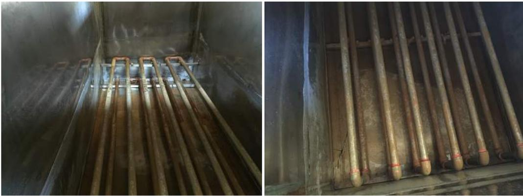
Figura 2.25: Scambiatore termico - Vasca di macerazione
