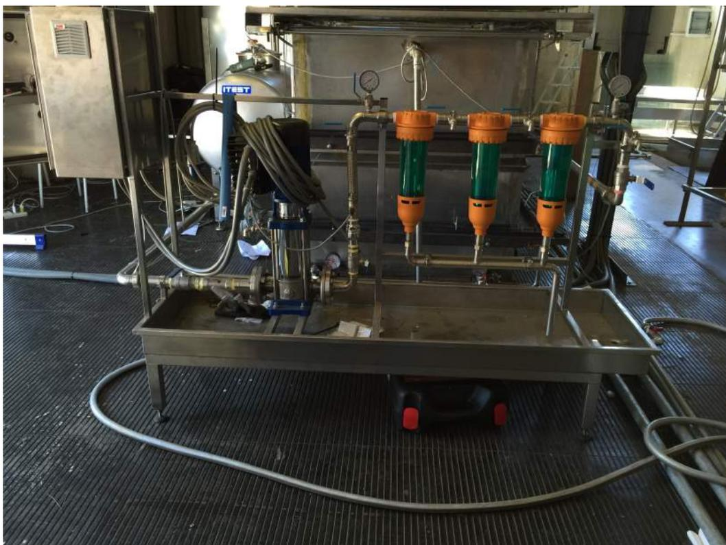
Figura 2.41: Filtri micrometrici
