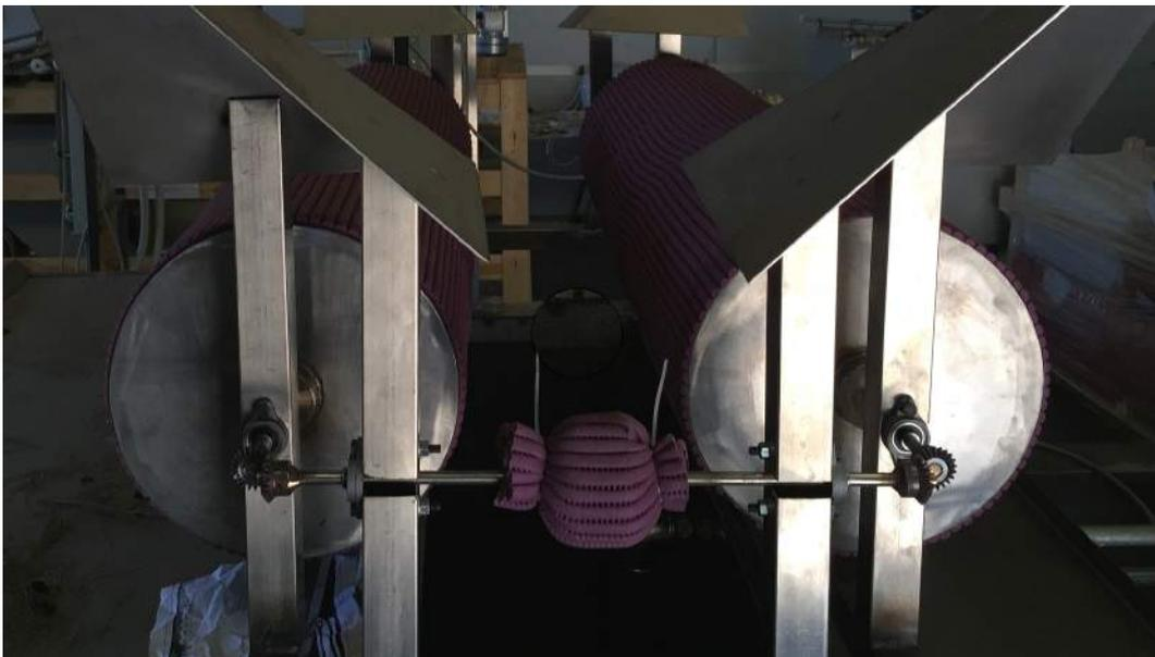
Figura 2.32: Sistema di trasmissione dei rulli
