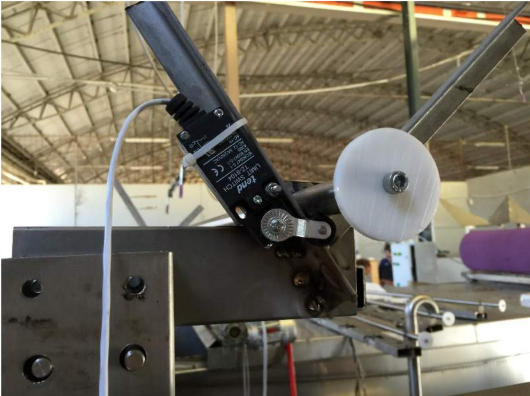
Figura 2.52: Finecorsa di azionamento
