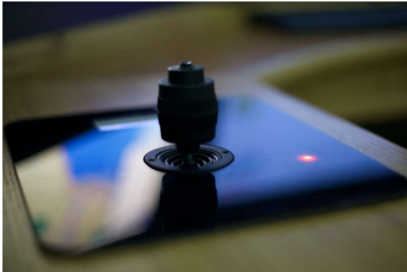
Figura 5.9: Dettaglio della replica della plancia del Rimorchiatore, joystick per il governo del rimorchiatore
