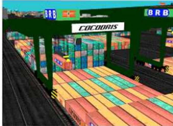
Figura 2.4: COCODRIS rail transtainer (fonte SimulationTeam, DIPTM, Università di Genova)
