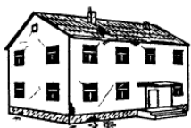
GRADO 2: danno moderato
