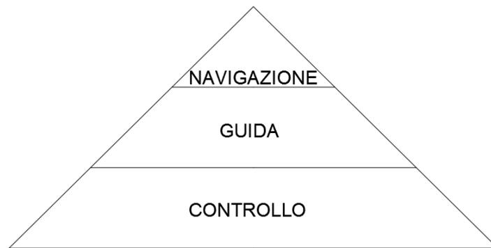
**Figura 2.1: SCHEMATIZZAZIONE DEL COMPITO DI GUIDA**
