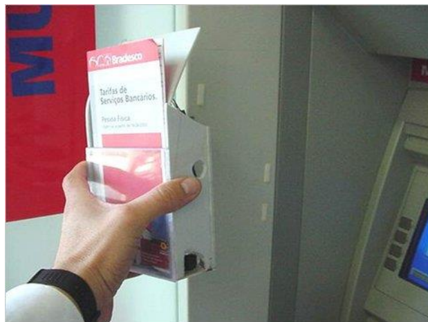
Figura 59. Un esempio di come i ladri nascondono una mini telecamera in un porta-brochure contenente materiale promozionale dell'istituto di credito dell'Atm
