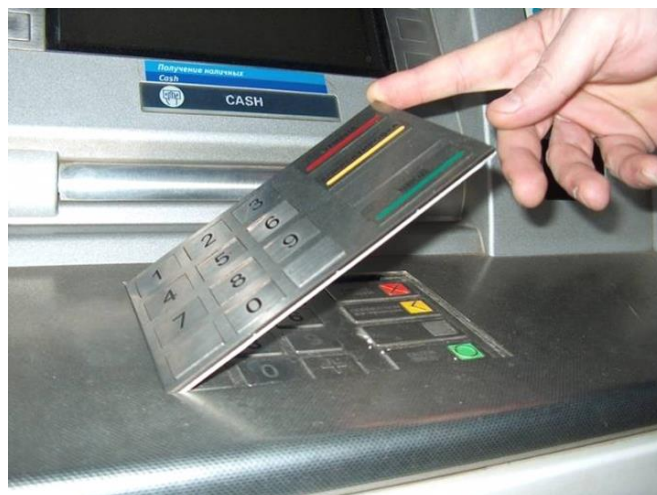
Figura 60. La tastiera originale è coperta da un finta per ingannare il cliente
