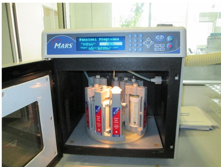
*Fig. 7. Digestione dei campioni in microonde e controllo di temperatura e pressione.*
