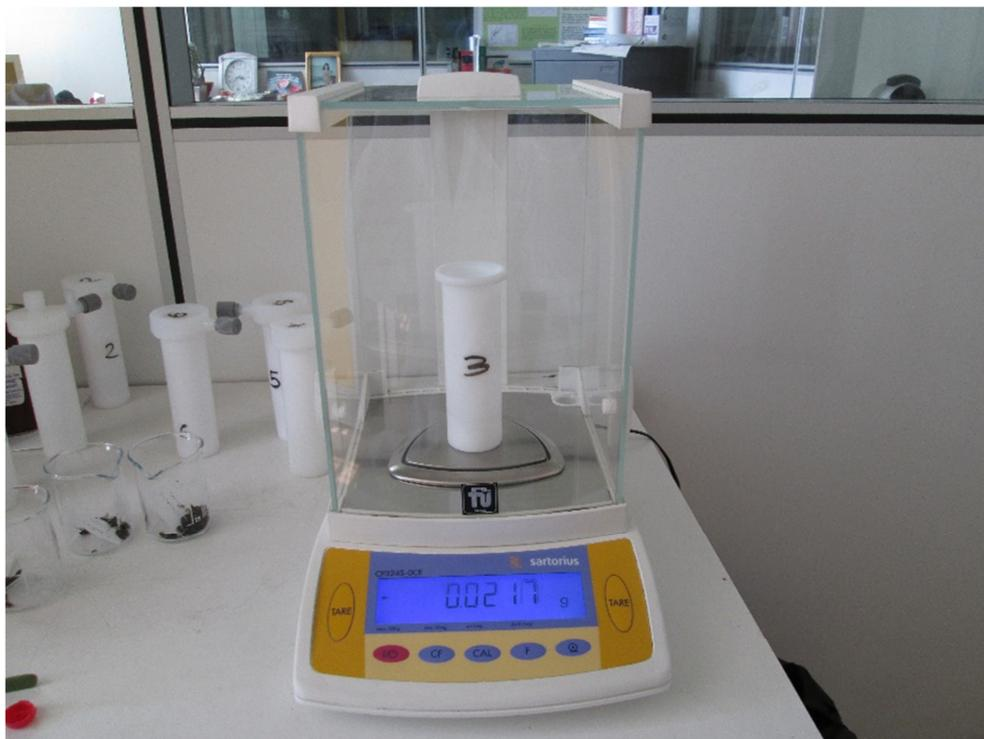
*Fig. 5. Pesata dei campioni con la bilancia di precisione.*
