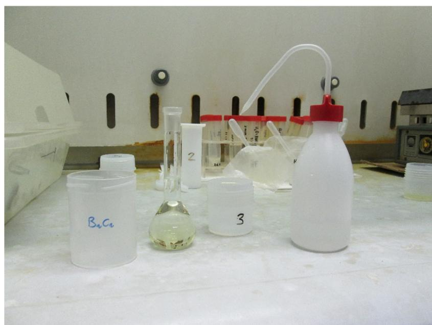
*Fig. 9. Utilizzo dei matracci graduati per portare i campioni a volume con acqua ultrapura.*
