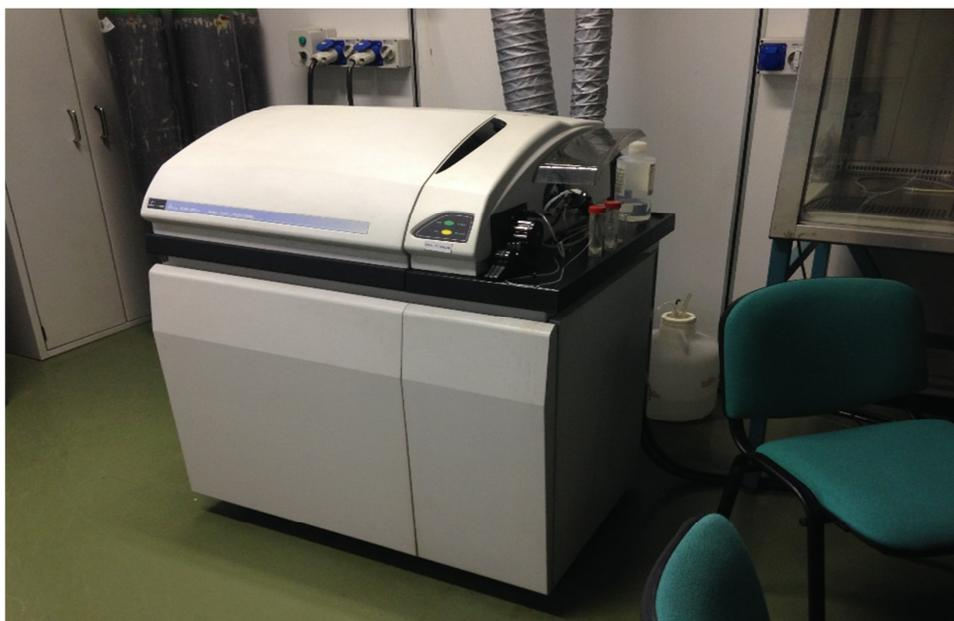
*Fig. 1. Strumento ICP-MS nel laboratorio dove è stata svolta l'attività di ricerca.*
