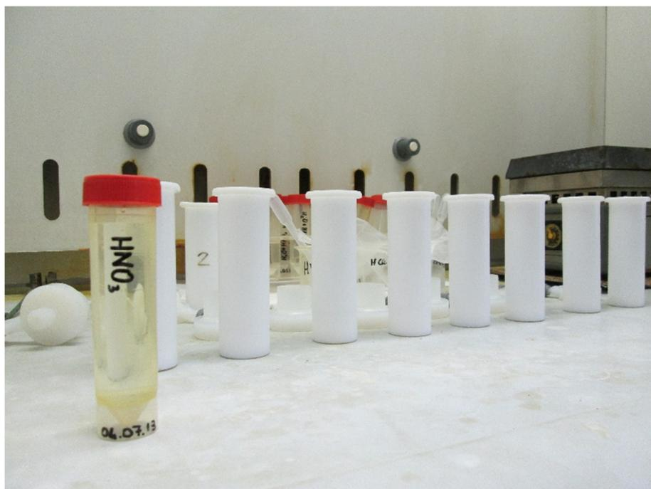
Fig. 6. Attacco acido dei campioni. I campioni organici sono stati attaccati con 10 ml di acido perclorico  $\text{HClO}_4$ .
