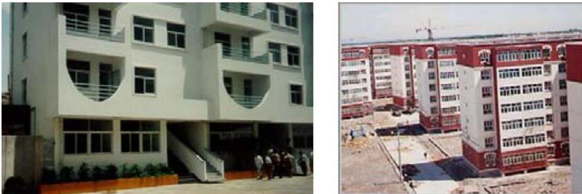
**Fig. 1.15. A sinistra: edificio residenziale isolato nel 1991 con HDRB a Shantou. A destra: complesso di 60 nuovi edifici residenziali in muratura isolati con HDRB.**
