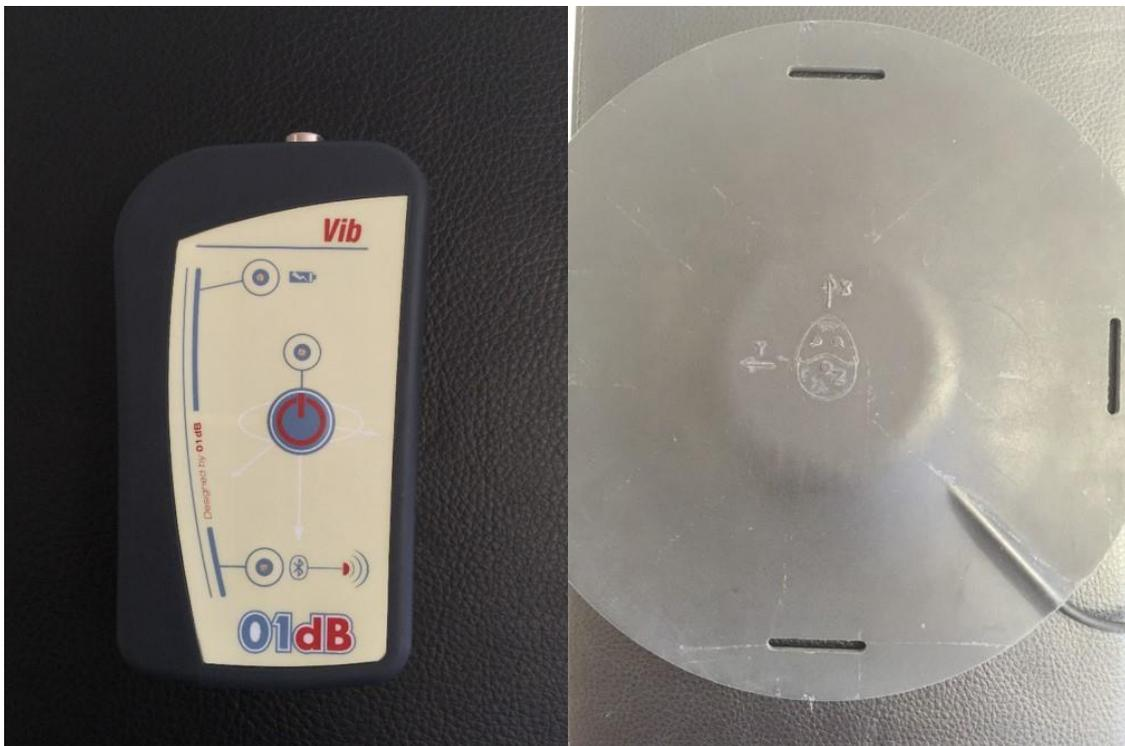
Figura 61: Dosimetro di vibrazioni VIB 008 01 dB con accelerometro
