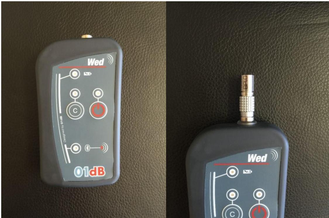
*Figura 63: Dosimetro di rumore WED 007 01 dB con microfono*
