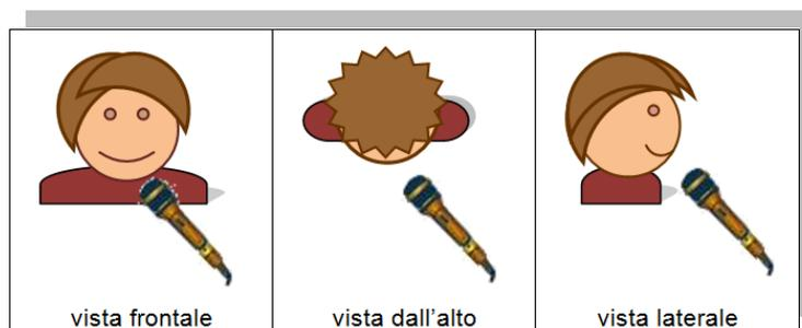
Figura 36: Disposizione del microfono con angolatura di 45° rispetto alla fonte di emissione
