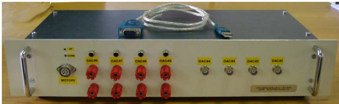
Figura 3.18: Pannello anteriore dell'elettronica di controllo interfacciata al computer e l'adattatore USB/RS-232.
