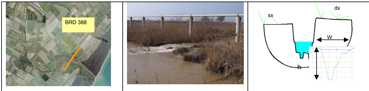
Figura 4.16. Sezione trasversale BRD388 del Fiume Bradano a valle della S.S. 106 jonica: ubicazione in planimetria (a sinistra), immagine fotografica (al centro) e schematizzazione (a destra).
