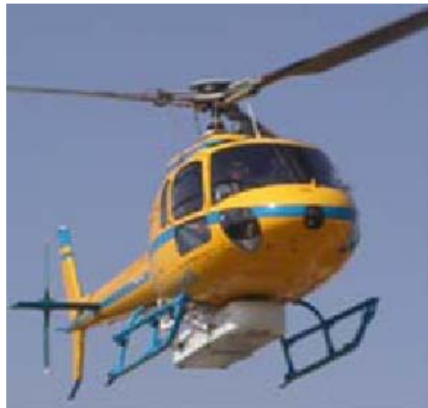
Figura 7.1. Esempio di alloggiamento della strumentazione laser per elicottero.
