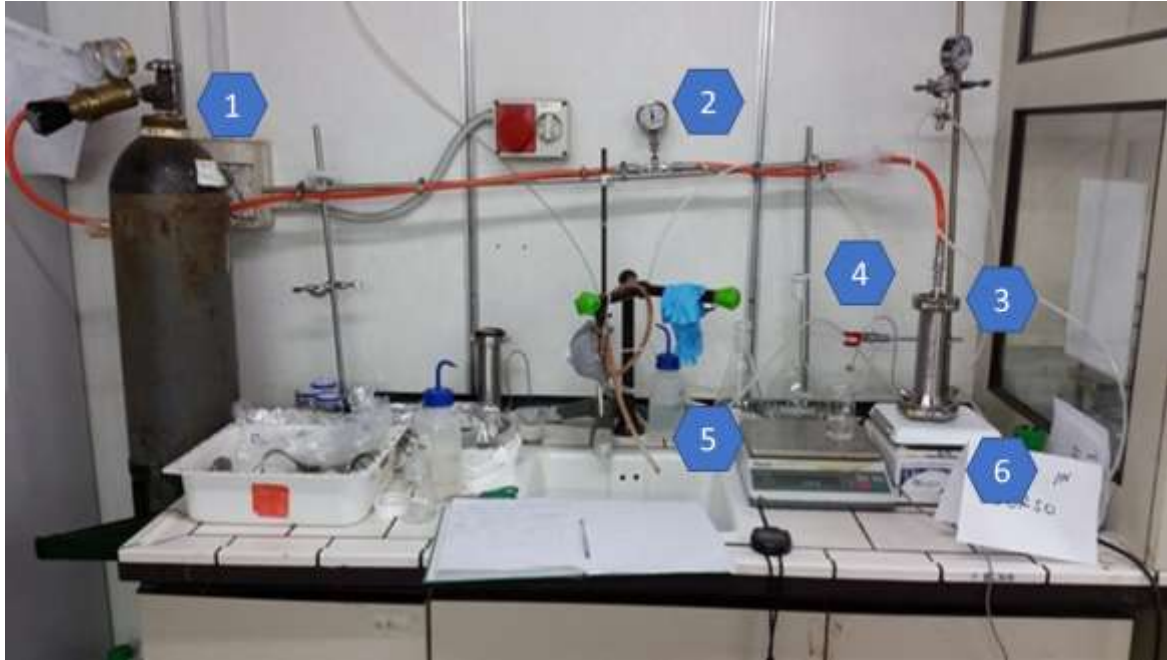
Figura 19. Diagramma schematico dell'impianto di ultrafiltrazione: 1. Bombola di azoto; 2. Manometro per la misura della pressione in ingresso; 3. Cella in acciaio inox contenente la membrana; 4. tubo collettore per la raccolta del permeato; 5. Bilancia digitale.
