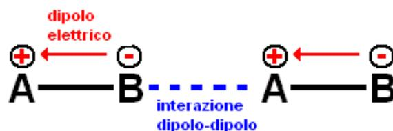
Figura 2.9 - Interazione dipolo-dipolo tra due molecole
