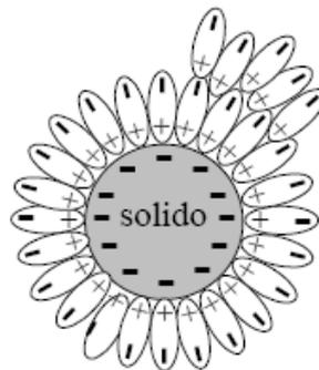
**Figura 2.6** – Orientamento delle molecole d'acqua intorno alla superficie della particella solida
