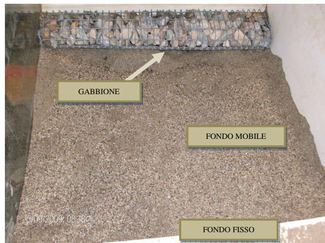
**Foto 5.1** – Gabbione di protezione posto a valle del fondo erodibile
