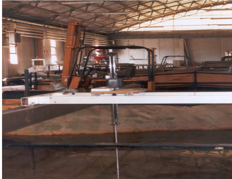
Fig. 4.4 Asta idrometrica per le misure dei livelli idrici nella vasca
