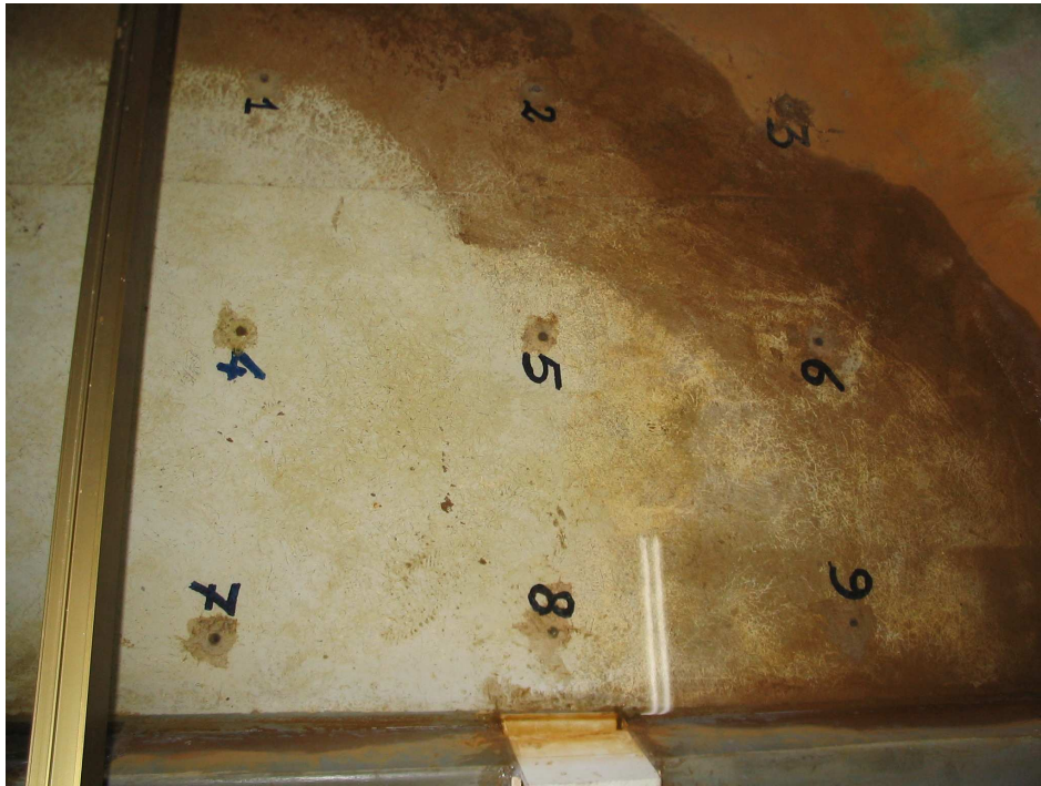
Fig. 4.5 Prese piezometriche nella vasca. Vista dall'alto
