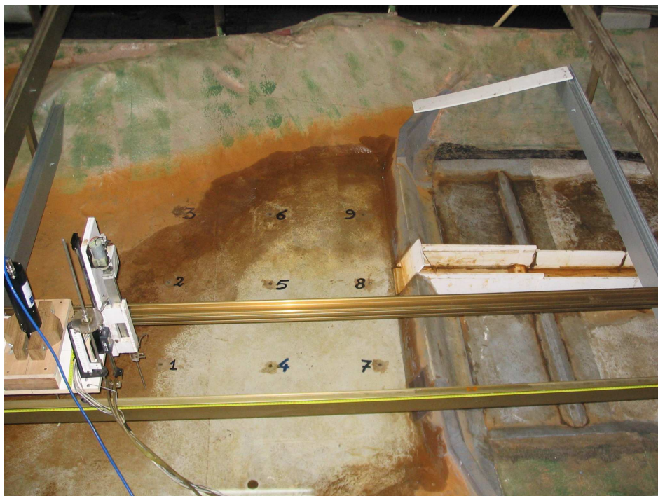
Fig. 4.6 Prese piezometriche nella vasca. Vista da destra
