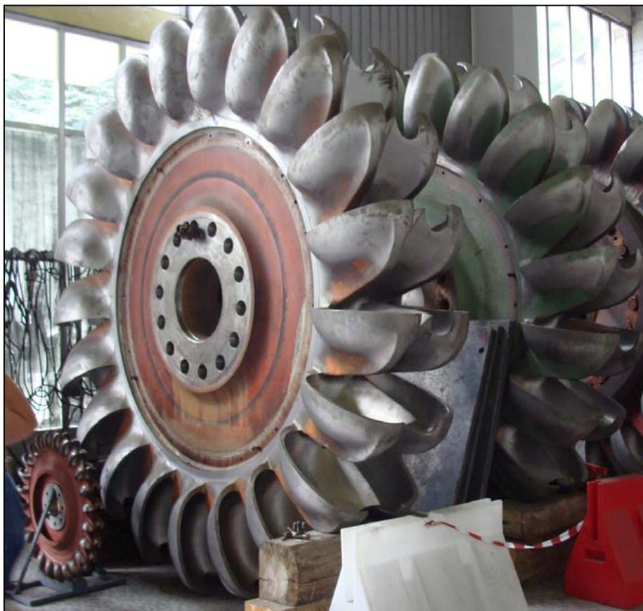
*Figura 4.38 - Turbina Pelton (diga di Place Moulin)*
