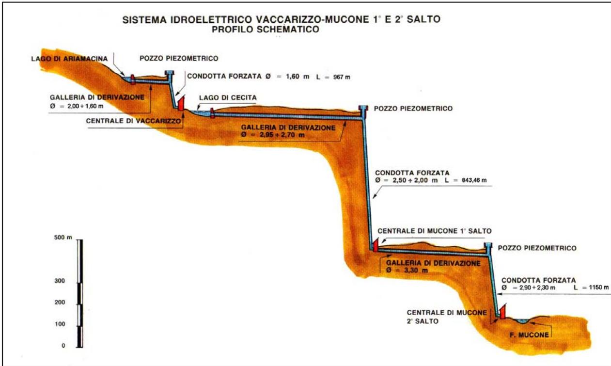
Figura 4.15 : sistema idroelettrico di Vaccarizzo - Mucone I salto - Mucone II salto, profilo schematico
