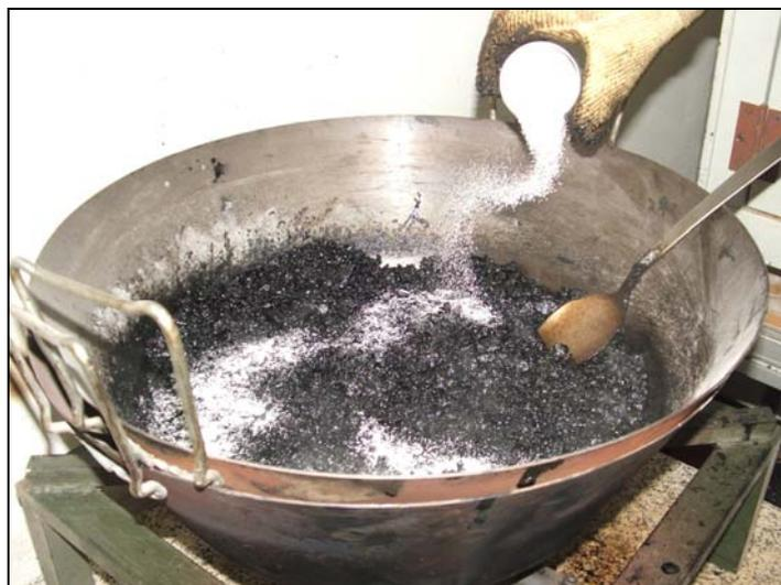
Fig. 6.7 – Un momento dell'aggiunta della zeolite alla fine della miscelazione del bitume
