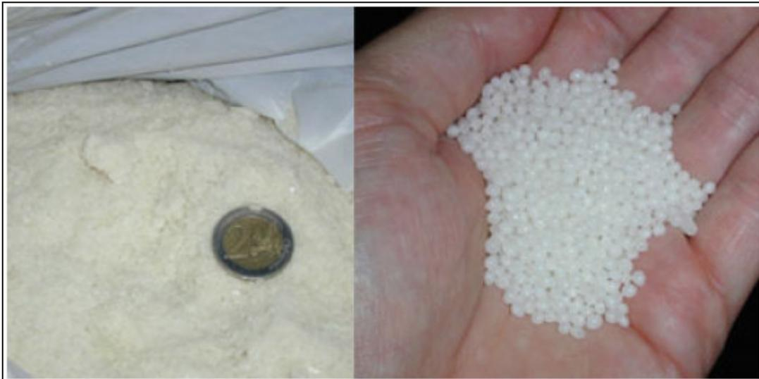
Fig. 4.4 - A sinistra Sasobit® in fiocchi, a destra sottoforma di palline
