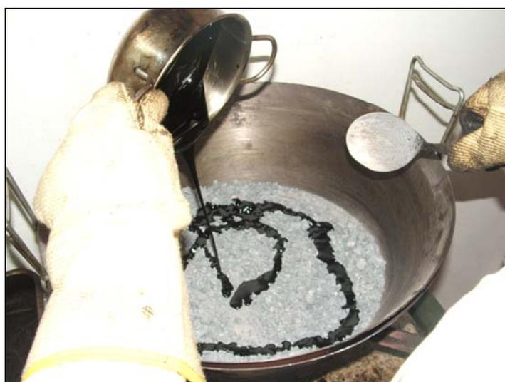
**Fig. 6.6** – *Un momento dell'aggiunta del bitume*
