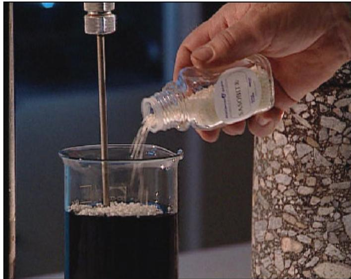
Fig. 4.5– Test reologico su un legante additivato con Sasobit®
