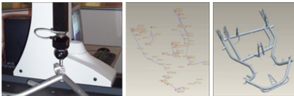
Figura 2.4: Processo di Reverse Engineering del telaio
