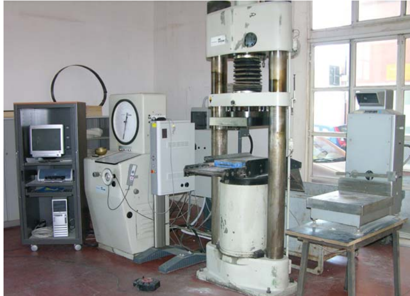
Fig. 5.9: Pressa elettromeccanica per prove di compressione uniassiale.
