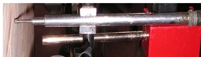
Fig. 5.7. -a: Comparatore centesimale; -b: Trasduttore lineare induttivo di spostamento.
