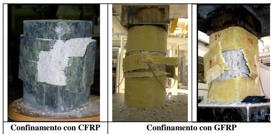
Fig.2.2 - Modalità di rottura di provini cilindrici e prismatici
