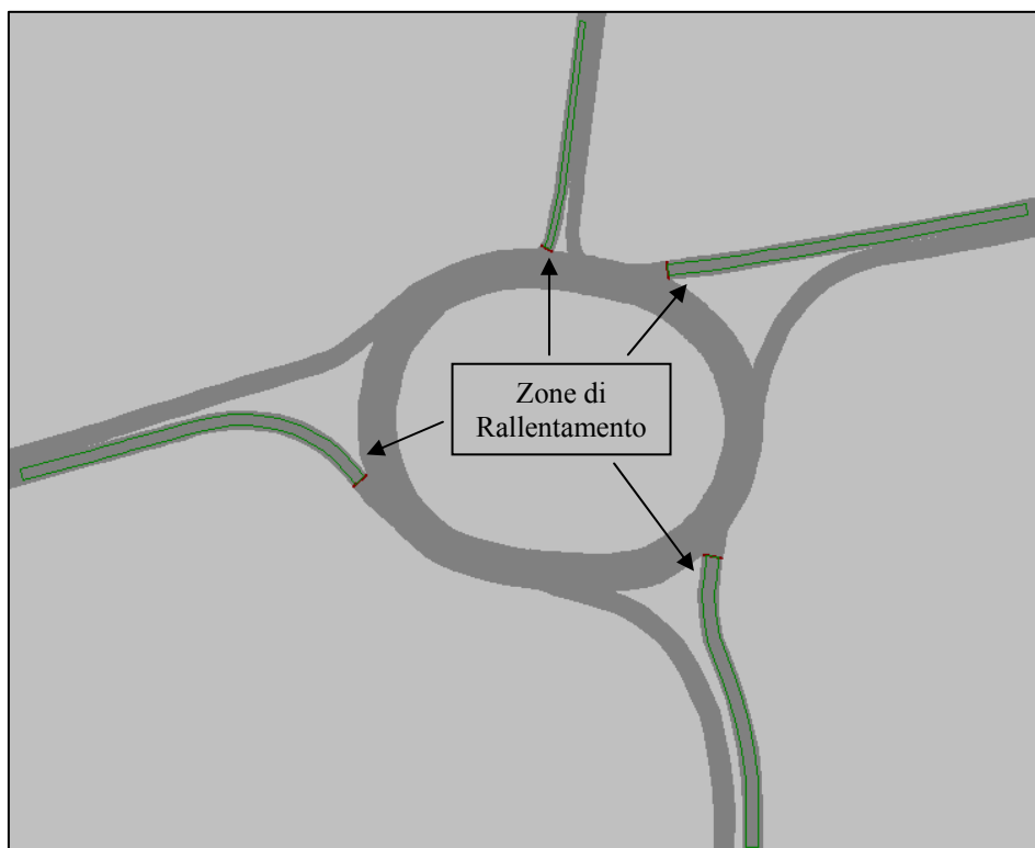
Figura 6.4: Posizionamento delle zone di rallentamento per la rotatoria di Cosenza Nord
