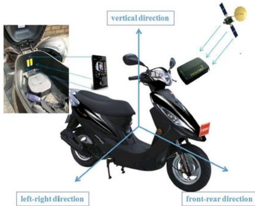
Figura 2.1.2.4.1 Architettura del sistema di monitoraggio.
